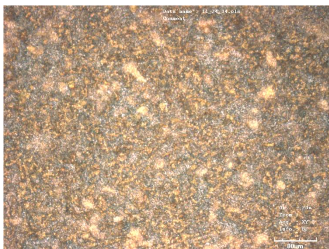
Figura 4.35. Superfície del Ti-64 després de 5 cicles
