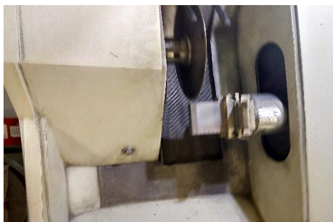
Figura 3.2. Struers Accutom realitzant un tall a una mostra de titani
