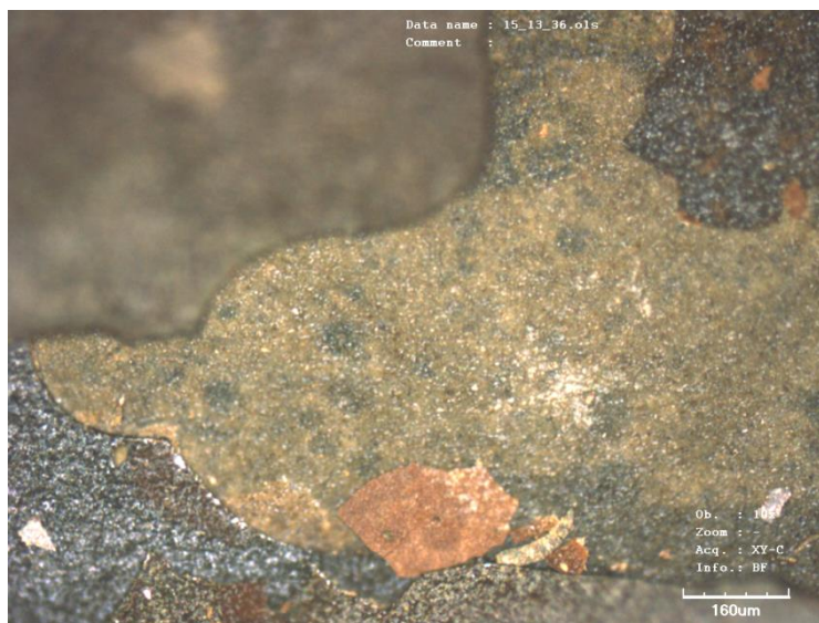
Figura 4.38. Òxid en la superfície del Ti-64 després de 500 cicles
