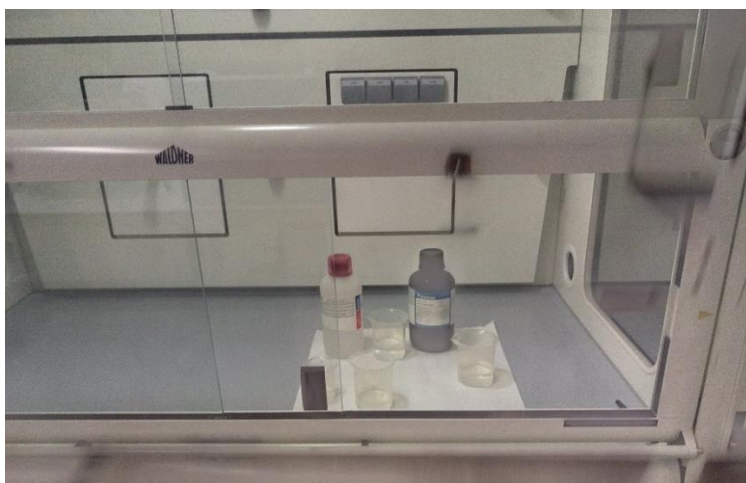
Figura 3.26. Recinte tancat adequat per realitzar l'atac químic amb garanties i seguretat
