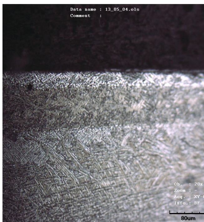
Figura 4.80. Mostra de Ti-64 després d'un tractament de 5 cicles on s'identifica capa- \alpha
