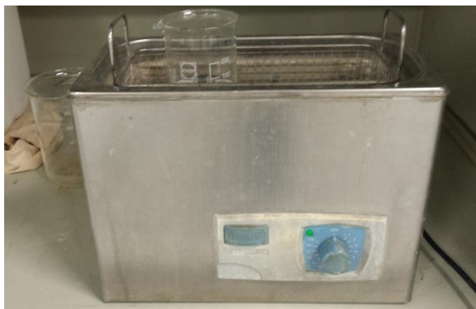
Figura 3.24. Aparell on es realitza la neteja per ultrasons
