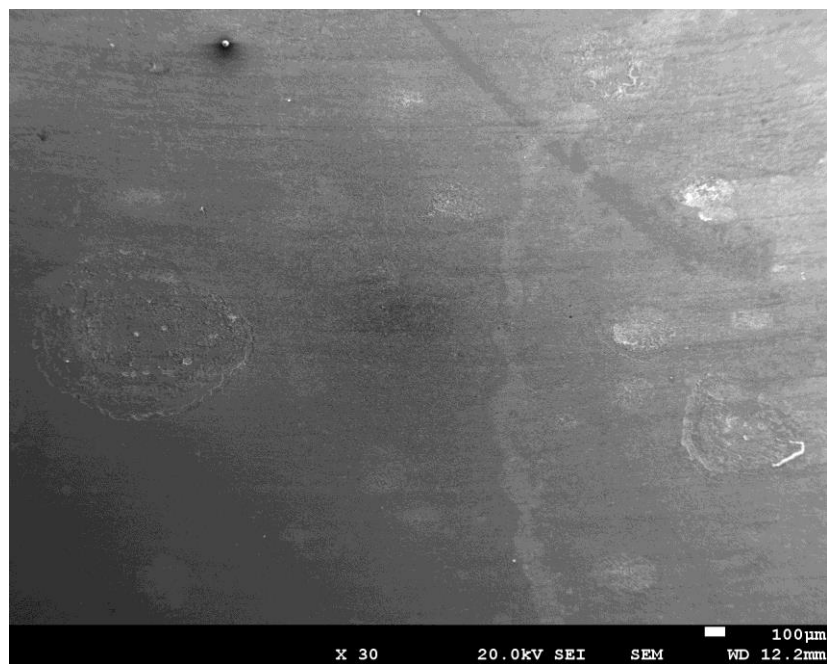
Figura 4.61. Formació d'òxid en el Ti-64 després d'un tractament de 5 cicles observada per SEI
