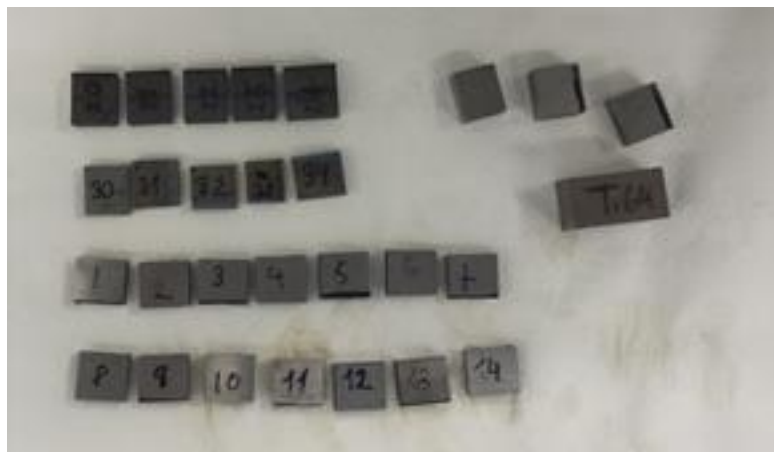
Figura 3.3. Mostres de Ti-64 tallades i numerades
