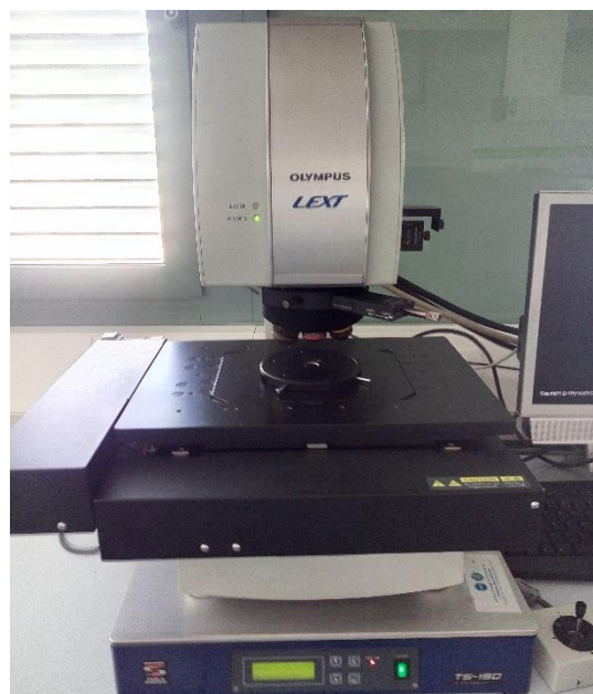
Figura 3.13. Microscopi òptic confocal Olympus LEXT
