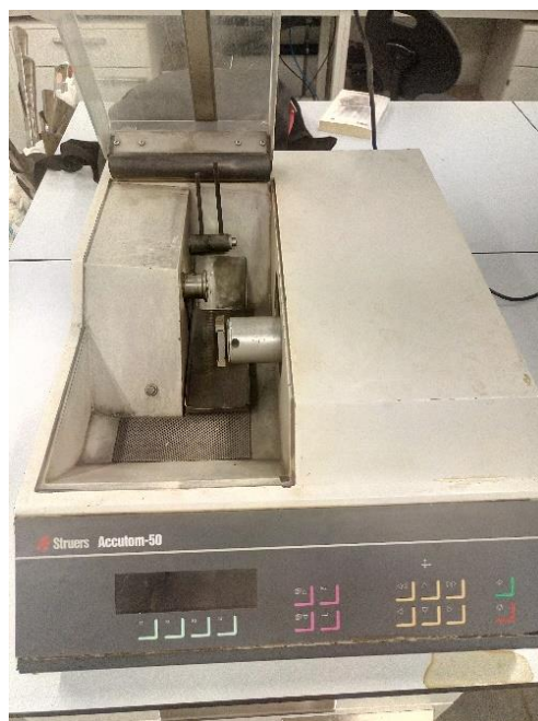
Figura 3.1. Màquina de tall Struers Accutom
