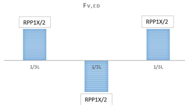
**Ilustración 4.71:** Diagrama de esfuerzos cortantes, a lo largo del bulón, donde el esfuerzo máximo es  $RPP1X/2$ . En esta imagen,  $L$  es la longitud total del bulón.
