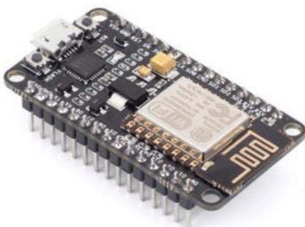
Figura 2: modulo Wi-Fi NodeMCU
