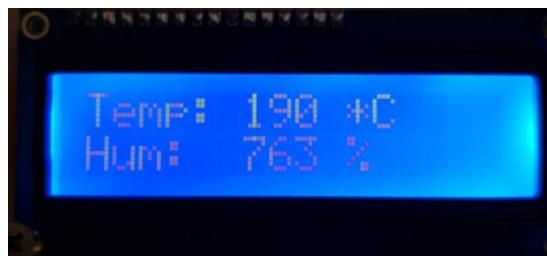
Figura 24: formato de los datos mostrados en el LCD
