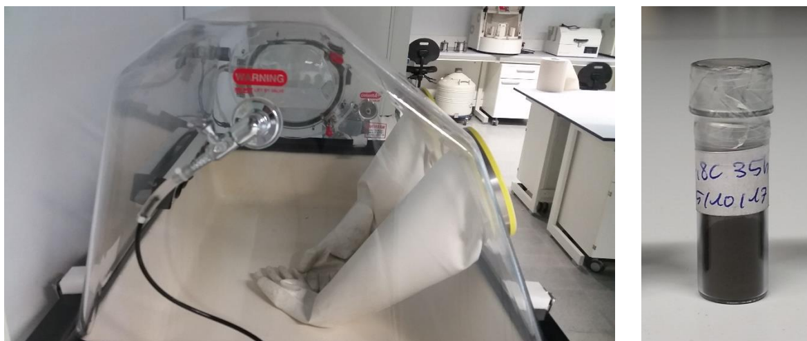
Ilustración 3-3 : Izquierda: Glovebox, cámara con atmosfera de nitrógeno. Derecha: Vial sellado con parafina.
