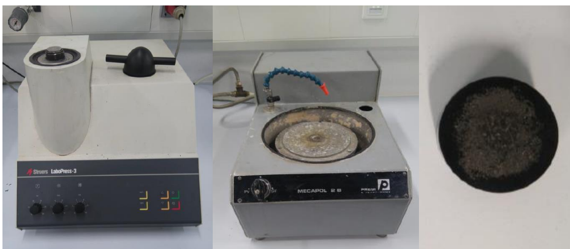
Ilustración 3-8: De izquierda a derecha: Embutidor Labopress-3, pulidora Mecapol y muestra de polvo embutida en baquelita
