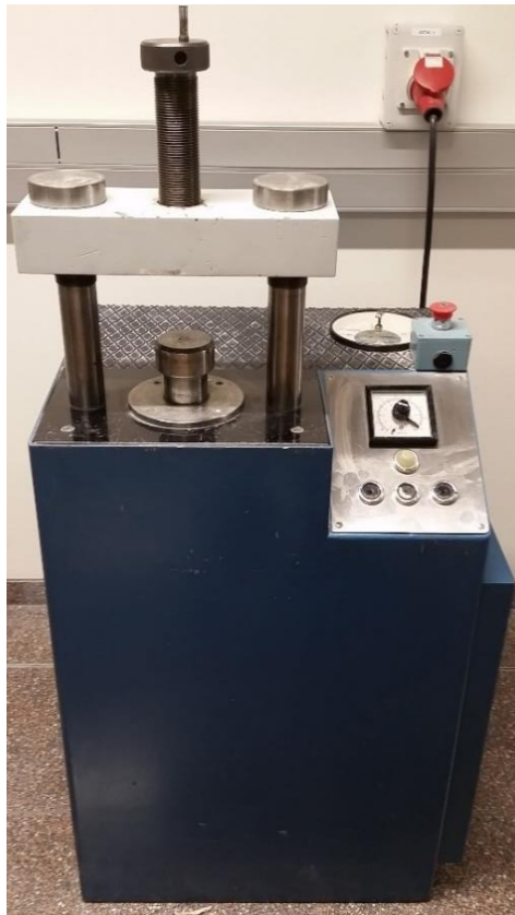
Ilustración 3-5: Izquierda: Prensa uniaxial utilizada para la compactación en frío. Derecha: INSTRON 8501 equipado con un horno de radiación
