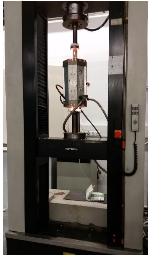
Ilustración 3-5: Izquierda: Prensa uniaxial utilizada para la compactación en frío. Derecha: INSTRON 8501 equipado con un horno de radiación
