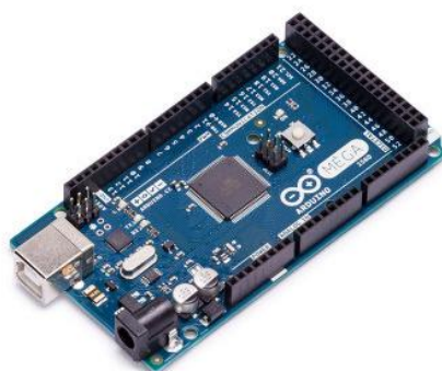
Figura 4.1. Arduino Mega (Fuente: www.arduino.cc )
