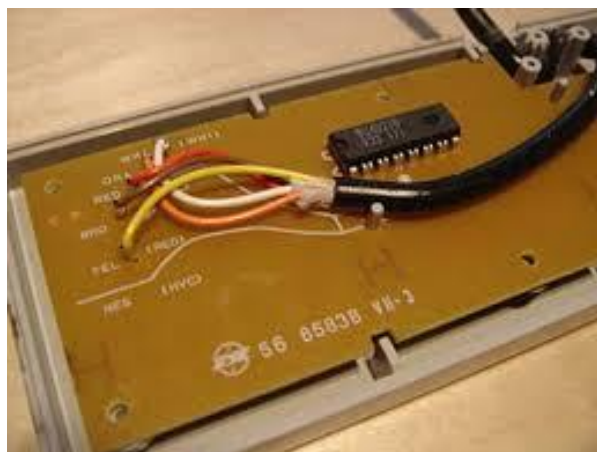
Figura 12. Interior d'un comandament de NES. ( http://circusmoonday.blogspot.com.es )
