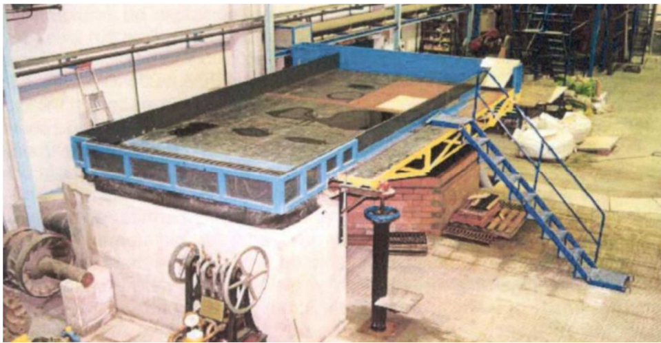
Figura 2: Plataforma de ensayo para rejjas e imbornales. (Fuente: Russo B., Gómez M., 2014)
