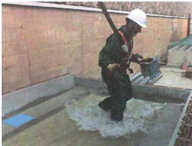
Figura 10: Individuo durante un ensayo con un caudal de circulación de 300 l/s y una pendiente longitudinal del 6%. (Fuente: Russo B., Gómez M., 2014)
