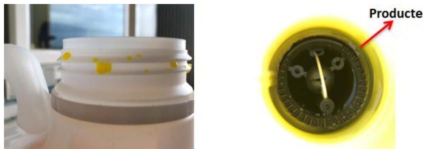
Figura 31: Restes de producte en la rosca del envàs i en l'adaptador.
