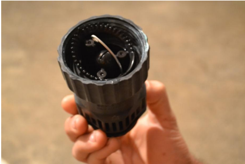
Figura 4: Adaptador per a envasos, en el que s'aprecia la rosca i el dentat interior
