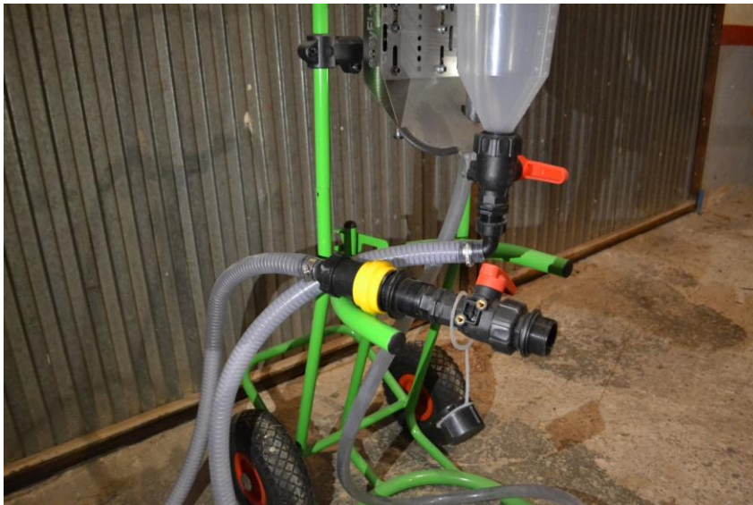
Figura 8: Detall de la mànega de 2" i el connector per a l'equip, amb vàlvula de pas.
