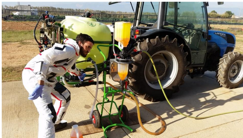
Figura 30: Incorporació de producte amb easyFlow M amb detall del mono amb els col·lectors adherits.
