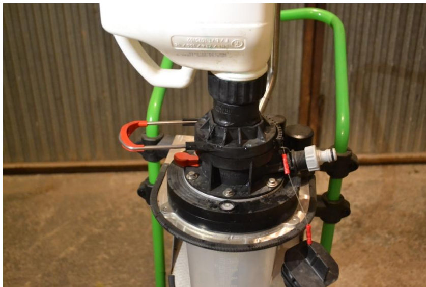
Figura 15: Maneta en posició de donar pas al líquid al vas de medicació del easyFlow M.
