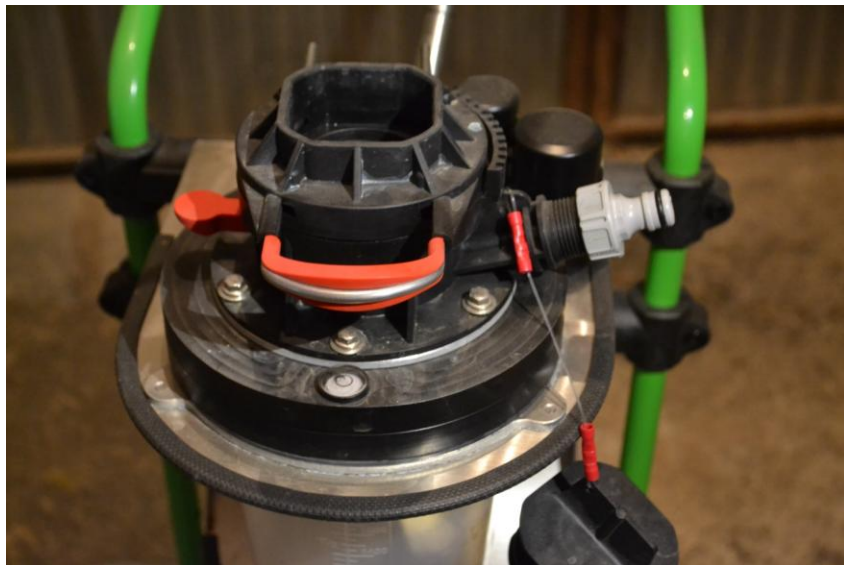
Figura 13: Adaptador amb la maneta en posició per connectar el adaptador per a envàs. Sota la maneta es pot apreciar el nivell del que disposa el easyFlow M.
