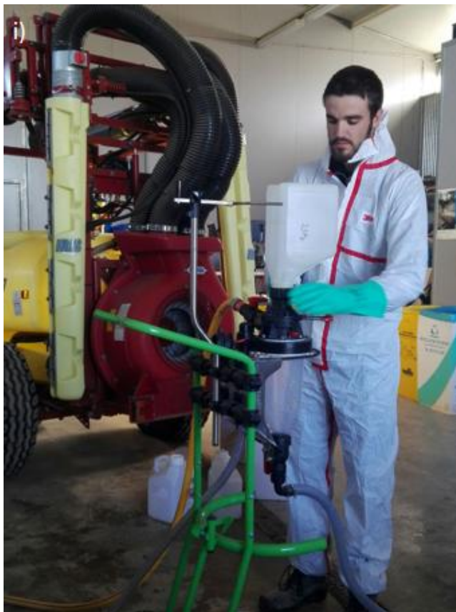
Figura 29: Procés de neteja del envàs amb el dispositiu easyFlow M.
