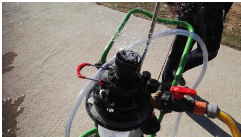
Figura 16: Detall del raig d'aigua que realitza la neteja del interior de l'envàs.
