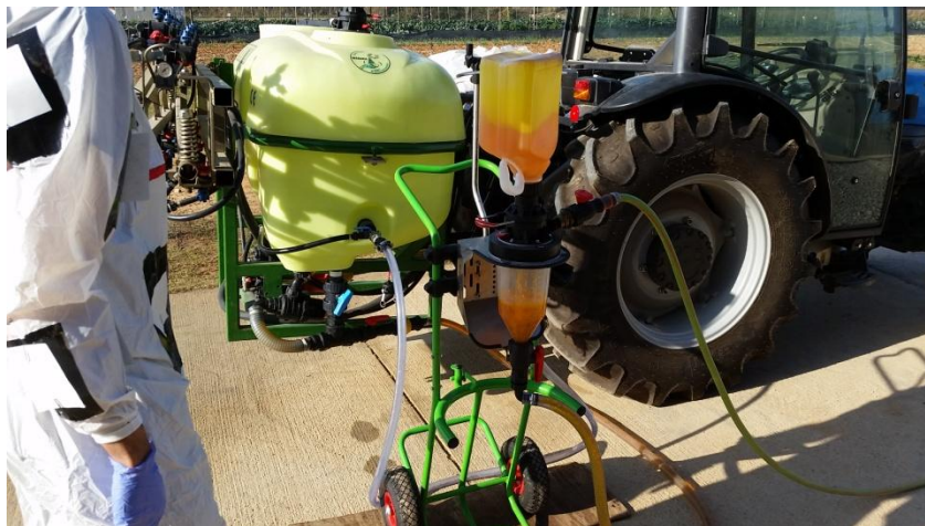
Figura 26: Procés d'incorporació de producte mitjançant el easyFlow M.
