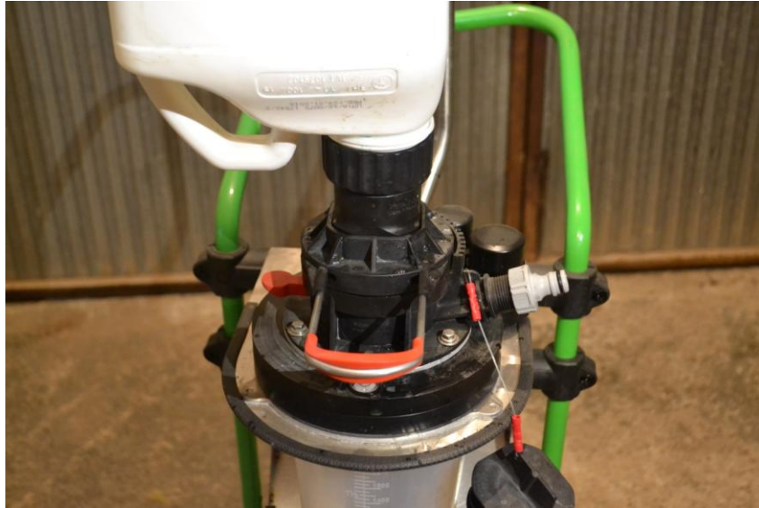
Figura 14: Envàs connectat al easyFlow M, amb la maneta ja estirada.
