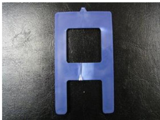
Figura 3.7: Ejemplo de línea de soldadura.
