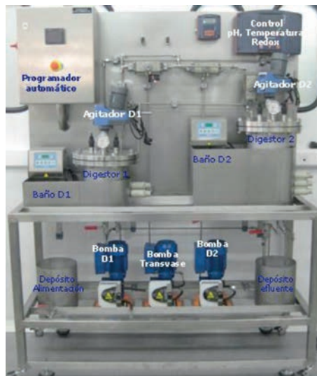
Figura 7.3. Planta piloto del proyecto Sludge4Energy en AINIA.
