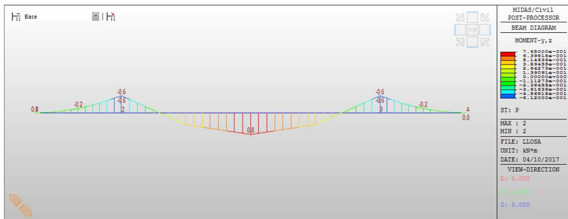
Figura 45: llosa-clau, resultat de la llei de moments Midas Civil
