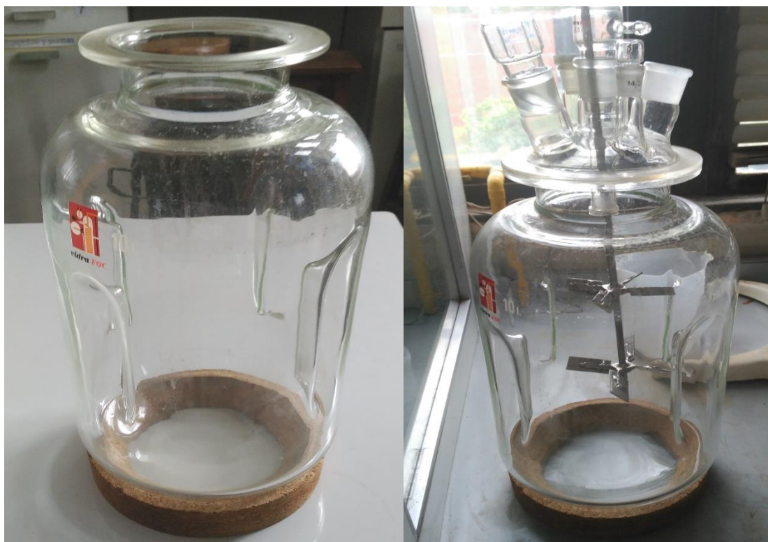
FIGURA 32. BIOREACTOR ANTES DEL MONTAJE A LA IZQUIERDA Y UNA VEZ MONTADO A LA DERECHA
