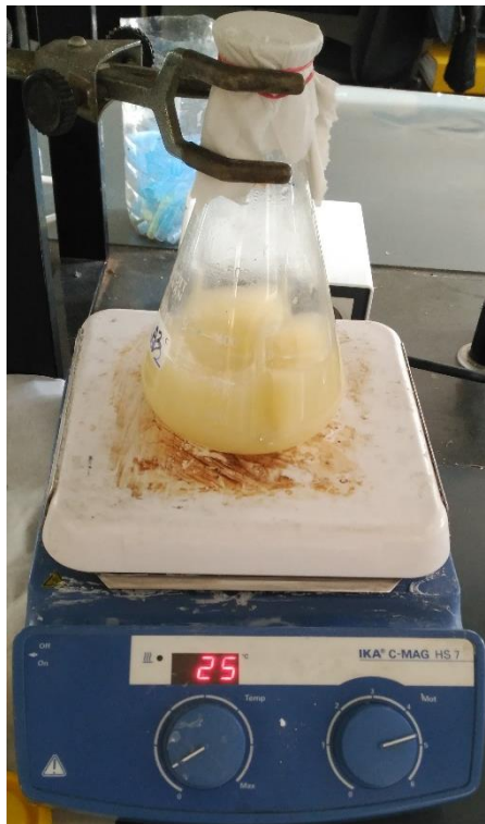
FIGURA 25: FERMENTACIÓ PARA LA OBTENCIÓ DE MASA BACTERIANA
