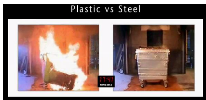
Figura 50. Comparación incendio en contenedor de plástico y de acero
