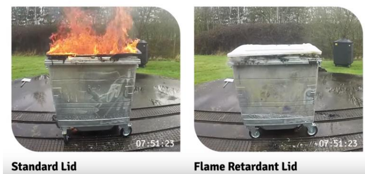
Figura 46. Comparación entre la quema de contenedores con tapa estándar o con tapa con retardante
