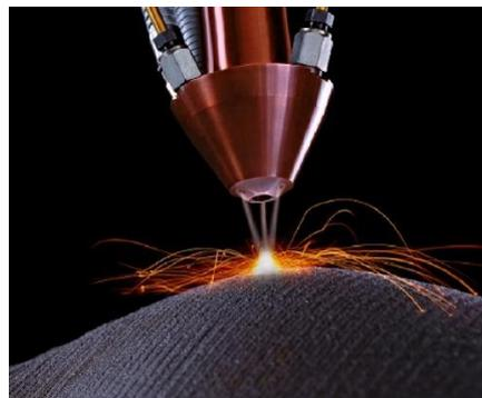
Figura 5: Detalle del cabezal durante el proceso LENS.
