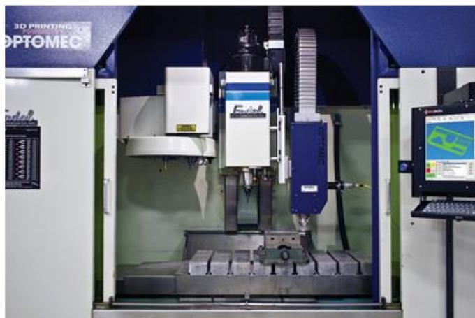
Figura 18: Detalle de la zona de trabajo de una impresora de tecnología LENS de Optomec.
