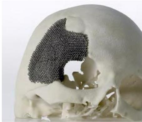
*Figura 20: Modelo de un implante metálico para cráneo humano.*
