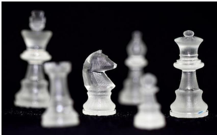
*Figura 13: Detalle de piezas realizadas por estereolitografía.*
