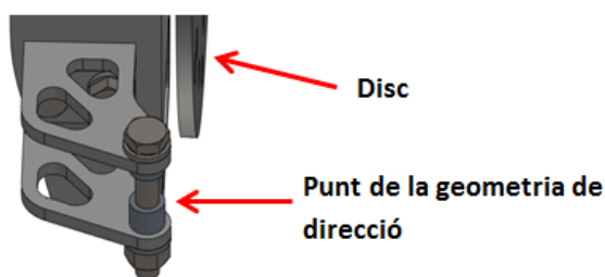
Figura 4.42 – Proximitat entre suport de la bieleta i disc
