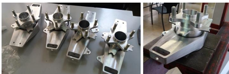
Figura 6.14 – Conjunt entre caixa i mangueta acabat de muntar
