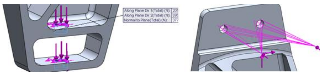
Figura 5.7 – Aplicació de les càrregues a L3F i la càrrega remota a U3F
