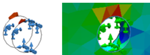
Figura 5.29 – Localització màxima de la tensió i la deformació (simulació C12).
