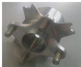
Figura 6.12 - Caixa posterior amb l'espàrrec ja muntat
