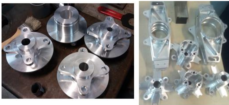
Figura 6.1 – Boixes en procés de fabricació (esquerra) i conjunt de boixes i manguetes acabades de fabricar (dreta)
