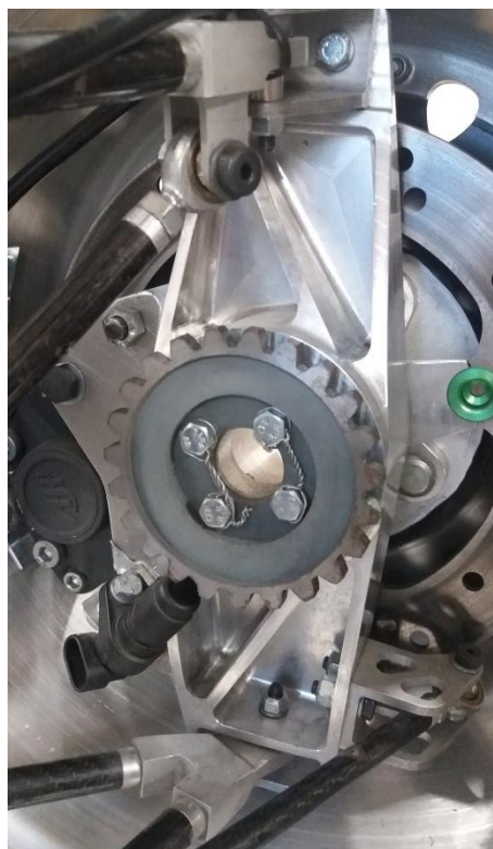
Figura 2.11 - Conjunt roda anterior muntat ne el cotxe
