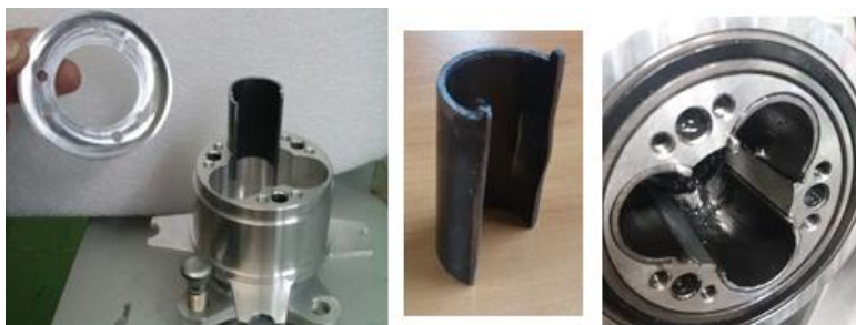
Figura 6.8 – Proves d'encaix amb l'esglaó del casquet acabat de llimar
