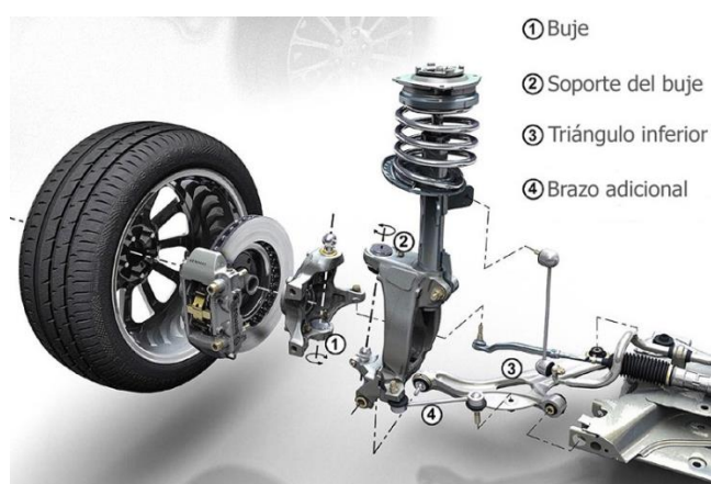
Figura 2.7 - Exemple de conjunt roda i massa no suspesa d'un turisme
