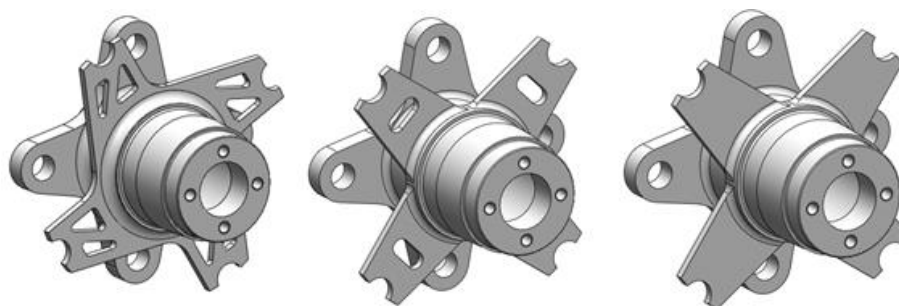
Figura 5.44 – Proves a les potes de la caixa
