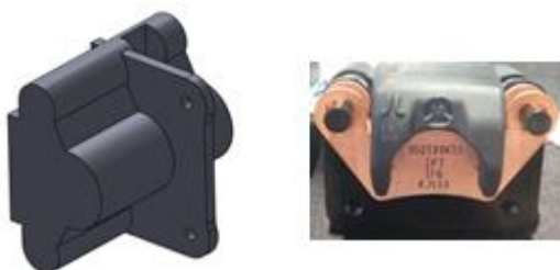
Figura 3.34 – Dibuix 3D propi de la pinça posterior i pinça real (dreta)
