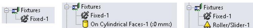
Figura 5.12 – Fixacions introduïdes al SolidWorks (C1, C2 i C3 d'esquerra a dreta, respectivament)
