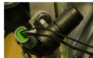
Figura 3.13 - Sensor hall utilitzat
