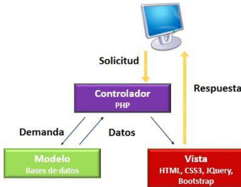
Figura 9. Esquema del funcionamiento del patrón Modelo-Vista-Controlador. Fuente propia.
