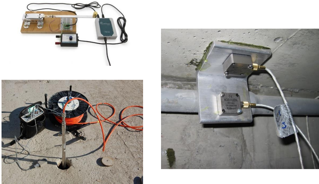
Figura 2. Galga, acceleròmetre i inclinòmetre
