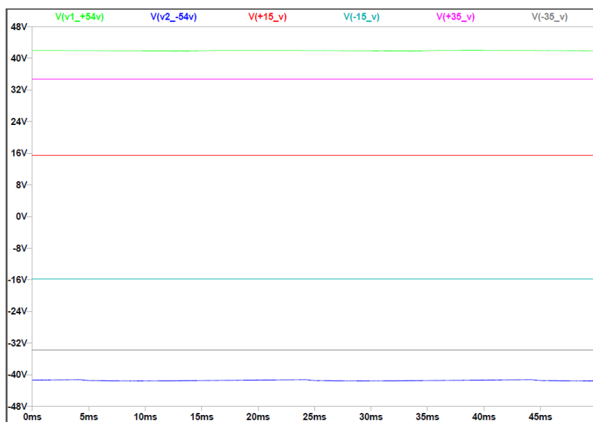
Figura 7.4. Fuente de alimentación diseñada en LTspice.
