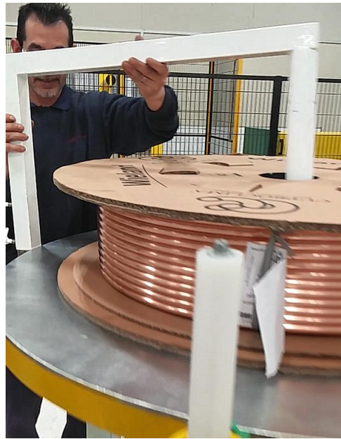
Fig. 14 útil para centrar la bobina en la bobinadora
