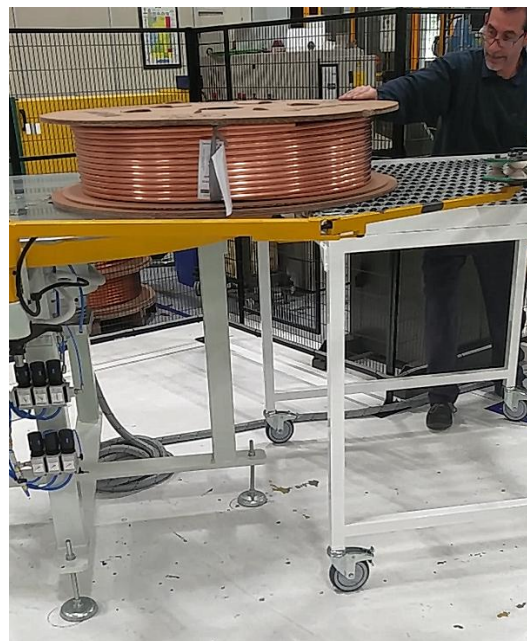
Fig. 15 carro que se implementó durante el SMED para transportar las bobinas
