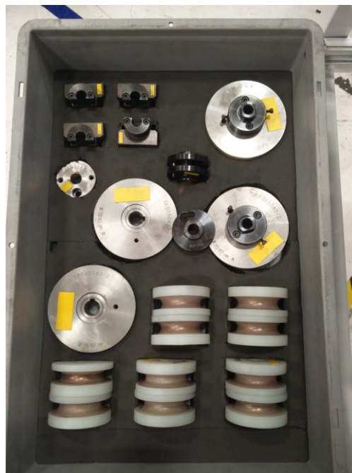
Fig. 17 espuma donde cada pieza de la máquina tiene su sitio
