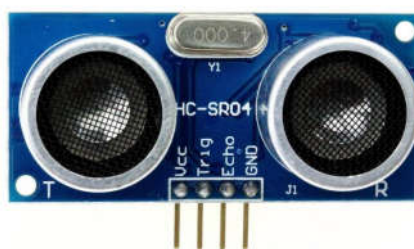
Fig. 4-9. HC-SR04 Ultrasonic sensor
