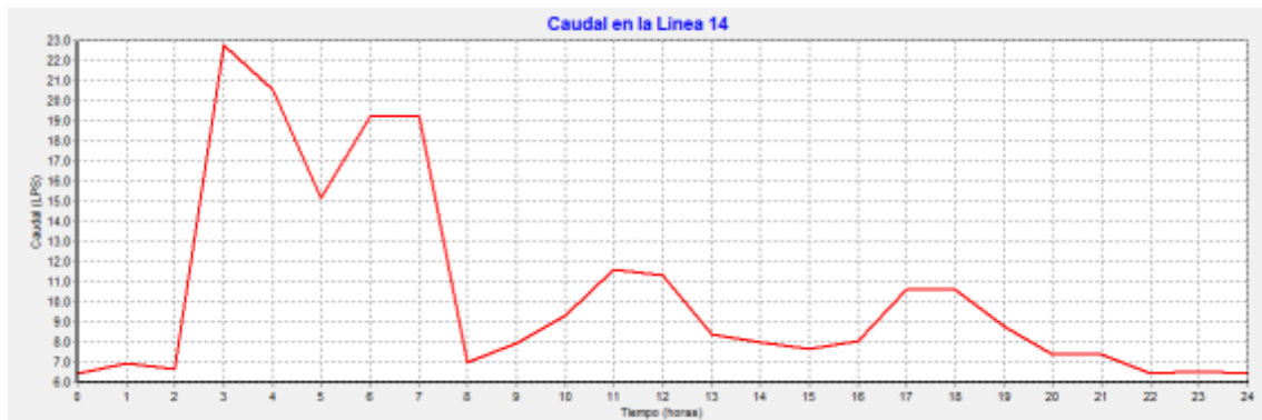
Figura 10.22 Caudal de la línea 14 con los hidrantes en funcionamiento. [Fuente: propia].
