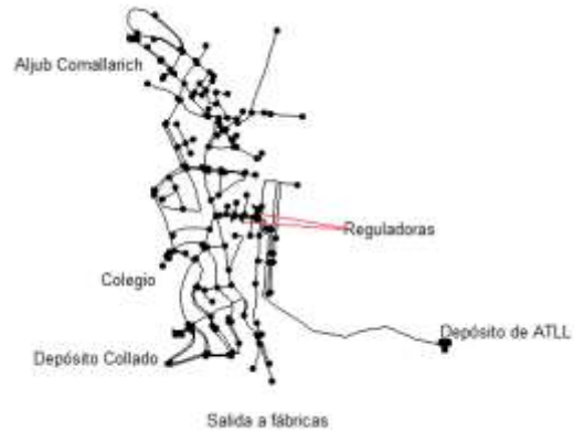
Fig.4. Red de agua potable del núcleo de Canyelles en la interfaz de EPANET
