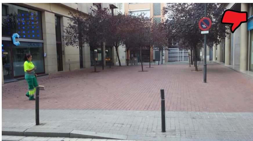
Espai recreatiu en la via pública amb la instal·lació de pilones que impedeixen la ubicació dels vehicles d'emergència en l'espai interior per accedir a les façanes del fons de la fotografia.
