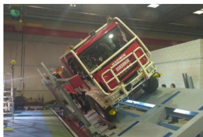
Figura 15.2 Assaig real de la prova de bolcada d'un vehicle per a donar conformitat a la UNE-EN 1.846 (font: UNE 1845)
