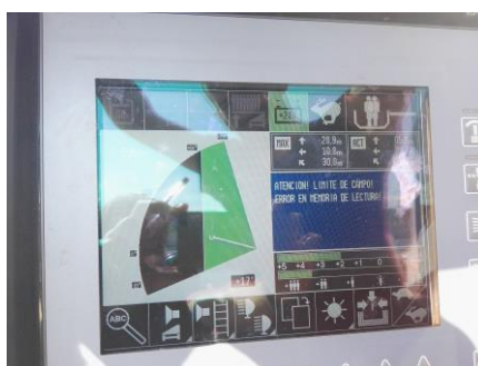
Figura 44.1 Pantalla d'ús d'autoescala per part del bomber operador on s'indiquen les dades necessàries que es van calculant i actualitzant de forma automàtica depenent de la situació real.
