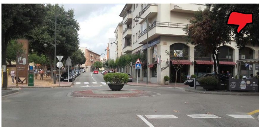
Glorieta en encreuament, la instal·lació d'elements en la glorieta franquejable dificulta greument el gir cap a carrers secundaris partint del carril principal.
