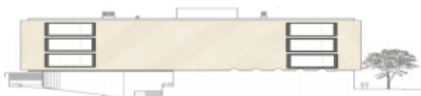
Figura 49. Imatge esquemàtica de la proposta constructiva requerida per la normativa francesa i alemanya en relació a la propagació del foc per façana.
