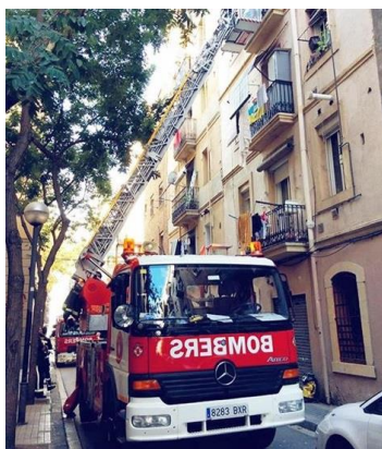
Figura 35. Imatge d'una intervenció d'autoescala (E-17) de Bombers de Barcelona on s'intueix la dificultat per al desplegament de les potes estabilitzadores en cas de vials amb circulació de vehicles i estacionament (Font: Instagram Bombers de Barcelona)
