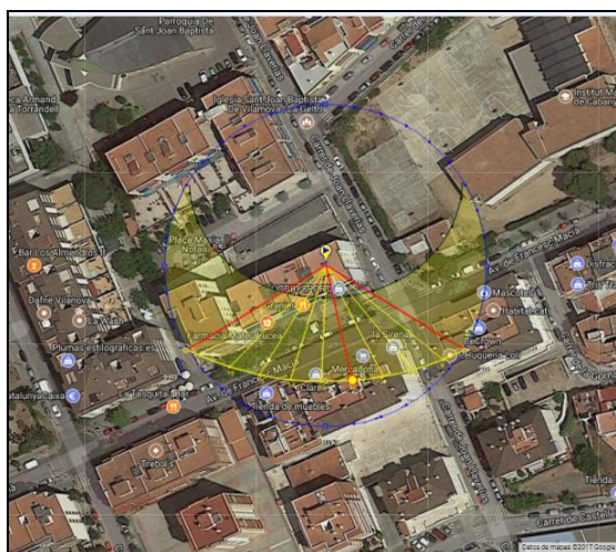
Figura 3.1: Trayectoria del sol y puntos donde es posible que se produzca sombra en la azotea
