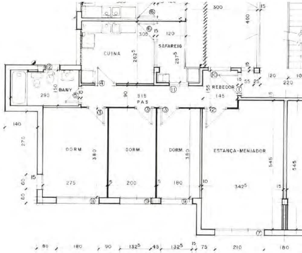
Figura 76.- Separació entre habitació i menjador amb mur de totxana. Vallbona I, Barcelona.
