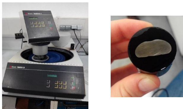
Figura 4.9: D'esquerra a dreta: Polidora automàtica Struers RotoPol-31 amb el disc de vellut; Peça de Ti cp de grau 2 acabada de polir i recoberta amb pols de Baquelita solidificada
