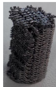
Figura A.13: D'esquerra a dreta: Gràfica de la resistència de compressió de la mostra 2 de Ti cp de grau 2. Resultat final de la mostra un cop acabat l'assaig de compressió
