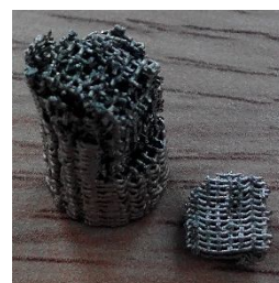
Figura A.17: D'esquerra a dreta: Gràfica de la resistència de compressió de la mostra 3 de Ti15Zr. Resultat final de la mostra un cop acabat l'assaig de compressió
