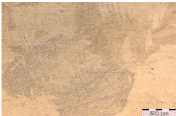
Figura 5.1: Superfície atacada de Ti cp de grau 2 obtinguda amb el forn d'arc voltaic
