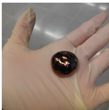
Figura 4.4: Peça de titani fusionada en el forn TITEC 205M OROTIG©
