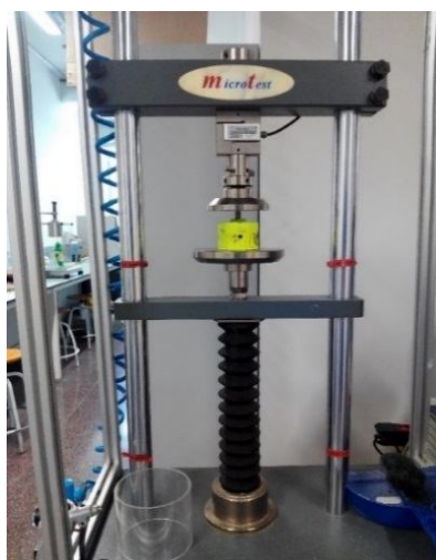
Figura 4.15: Màquina elèctrica d'assaig de compressió MicroTest realitzant un assaig per una mostra d'aliatge impresa en 3D
