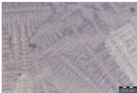
Figura 5.3: Superfície atacada de Ti13Nb13Zr obtinguda amb el forn d'arc voltaic
