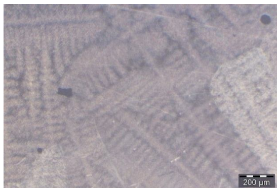
Figura 3.12: Exemple de dendrites
