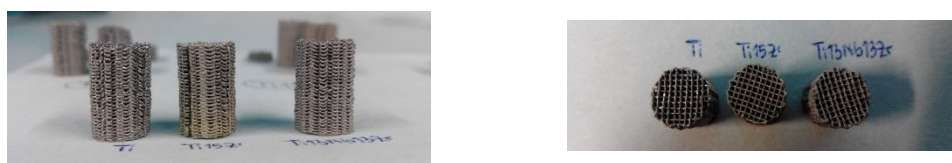
Figura 4.8: D'esquerra a dreta: vista de l'alçat de les figures d'1,3cm, la primera correspon a una de les peces de Ti cp de grau 2, la segona de Ti15Zr i la tercera de Ti13Nb13Zr; vista de la planta de les peces anteriors, comprovant que la base, i per tant la geometria, no s'ha modificat en el procés de sinteritzat
