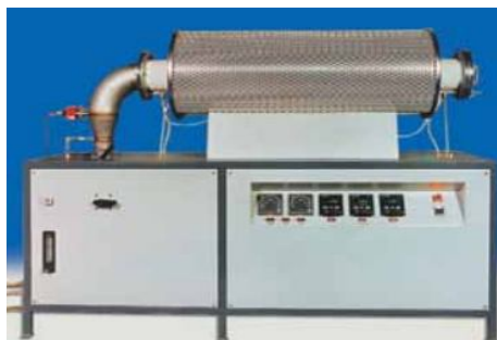
Figura 4.7: Forn Carbolite® Tubular amb buit
