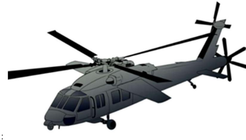
**Figura 5.1.** *Girodino basado en el UH-60 con alas y propulsor trasero. [8]*
