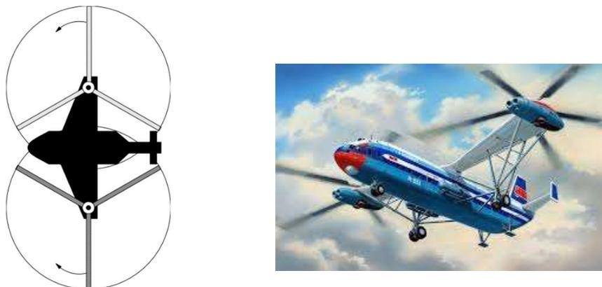
Figura 3.12. Helicóptero de configuración tándem lateral [2]
