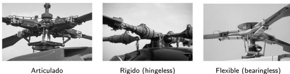
Figura 3.21. *Sistemas de fijación de las palas del rotor[2]*
