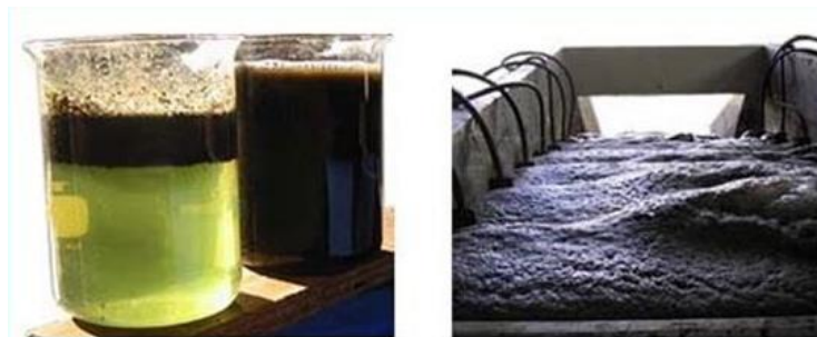
Figura 18. Separació per floculació - flotació
