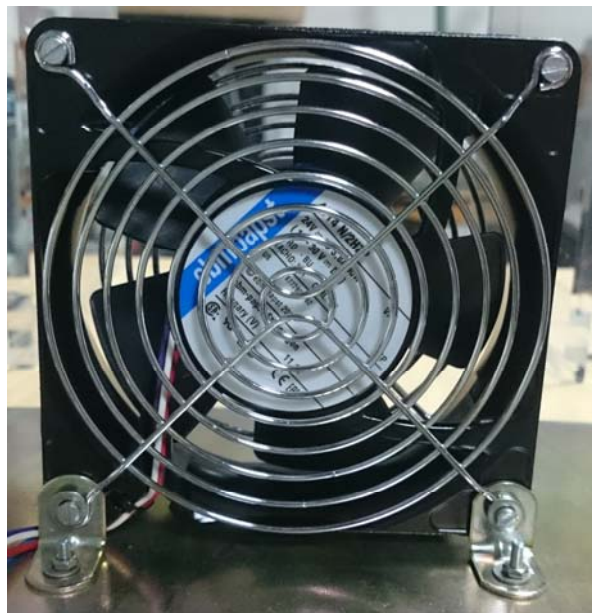
Il·lustració 27 - Ventilador definitiu ebm-papst 4114N/2H7P
