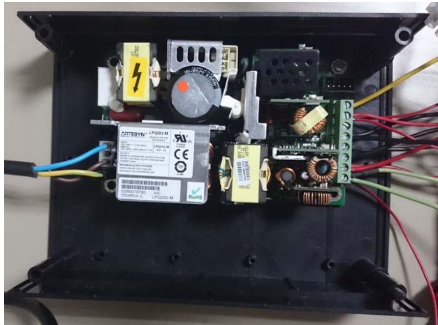
Il·lustració 14 - Font d'alimentació +24V / +5V / +12V / -12V
