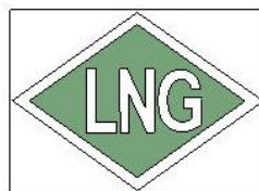
Figura 56. Símbolo del depósito GNL.
