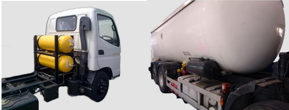
Figura 42. Localización depósito parte trasera cabina en camiones.
