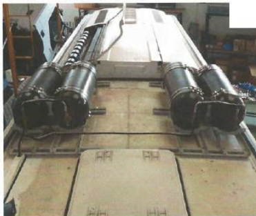
Figura 43. Localización depósito zona superior cabina en autobuses.
