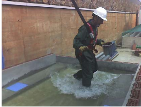
Figura 8.- Individuo durante un ensayo (Caudal de circulación de 300 l/s y pendiente longitudinal del 6%).
