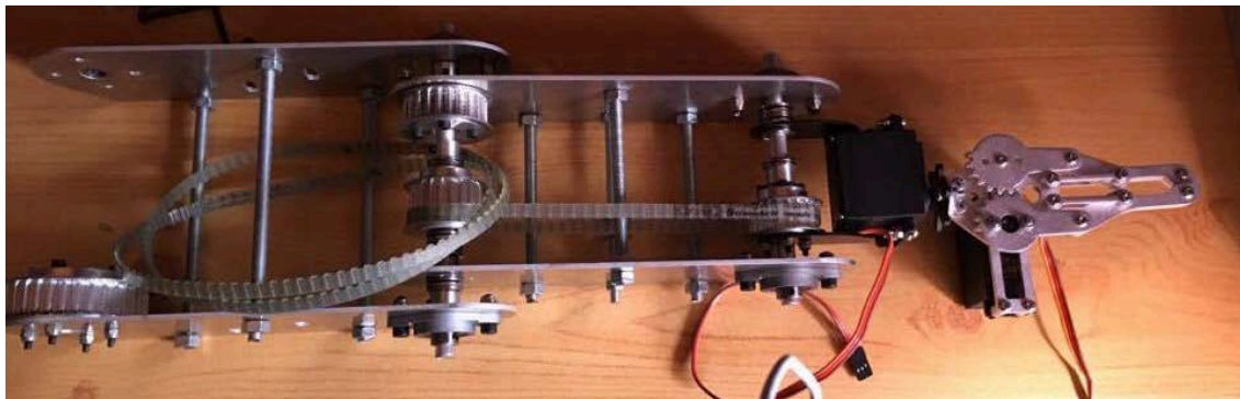
Ilustración 96. Montaje estructura del brazo
