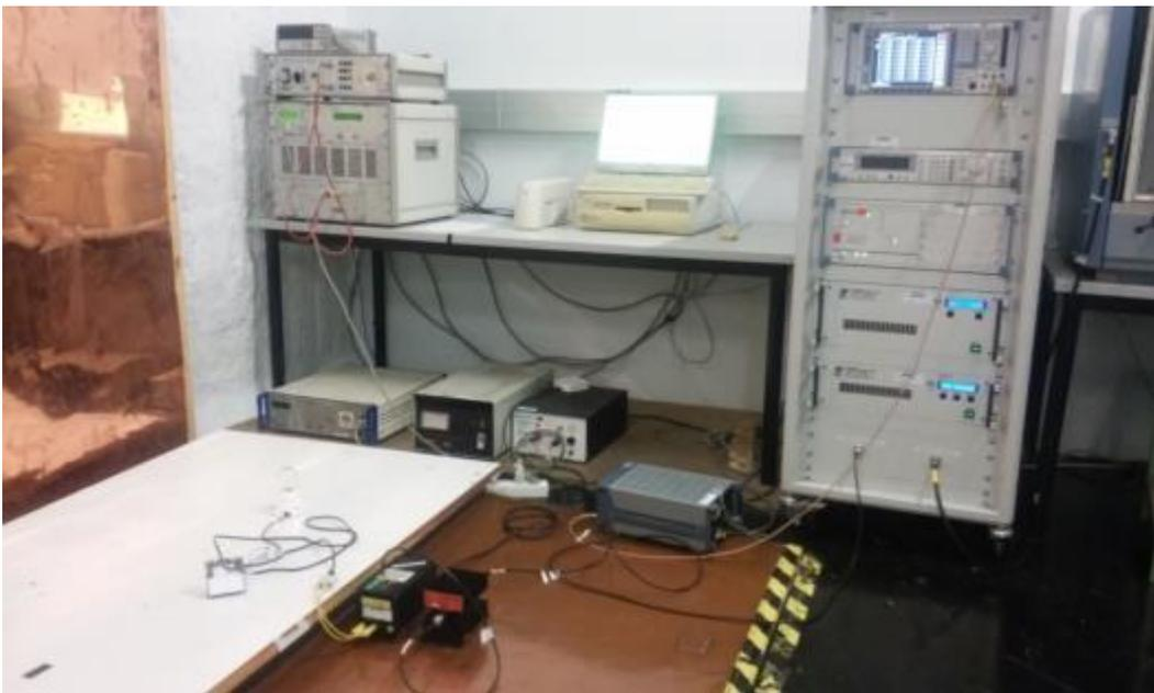
Ilustración 24: Set-up del ensayo de Inmunidad Conducida para la versión self
