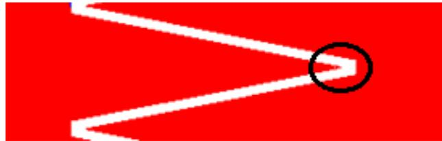
Ilustración 55: Vista ampliada del dentado de un electrodo interdigitated centrado en la distancia entre el cuerpo sólido y el puntal del diente del electrodo contiguo
