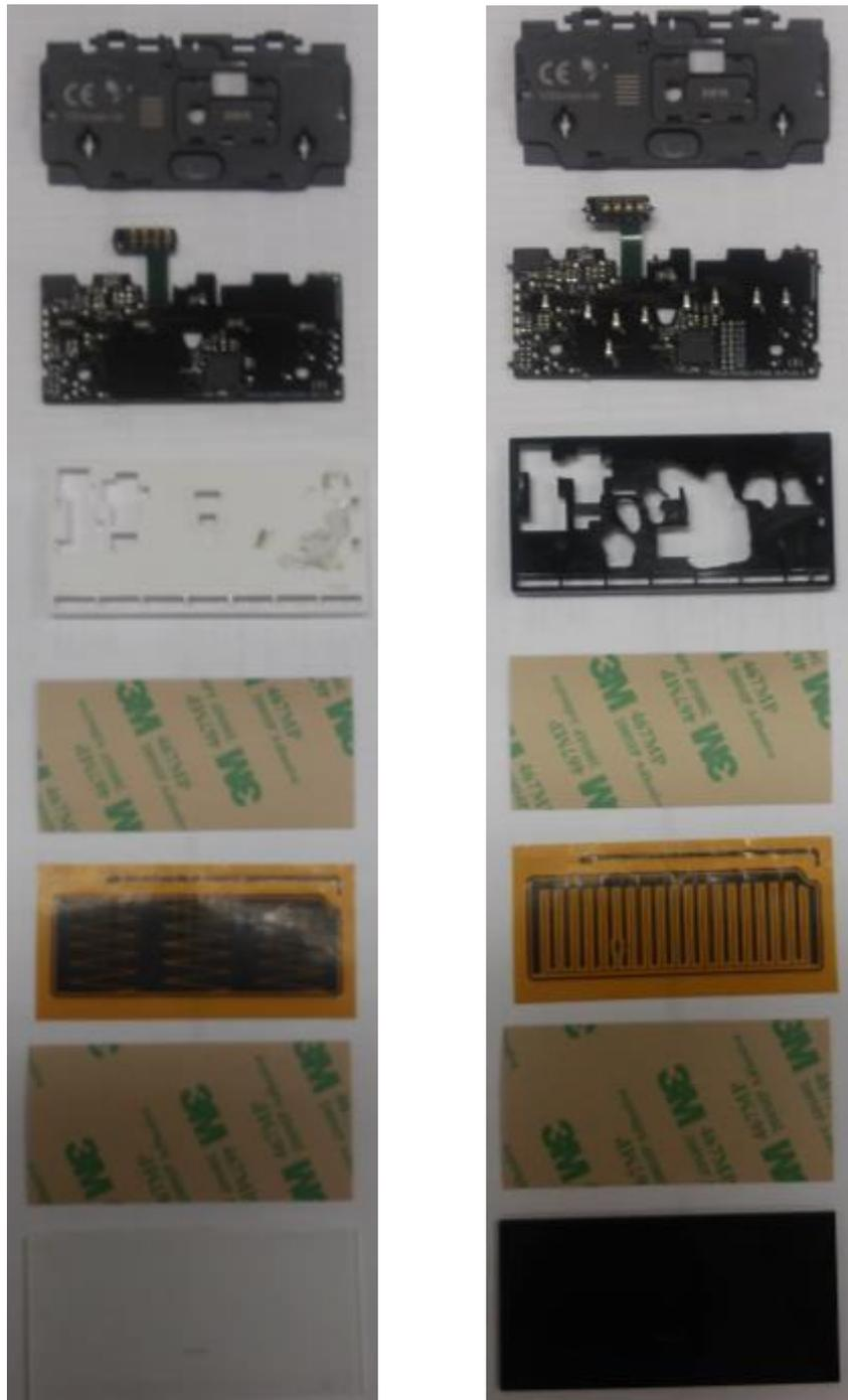
*Ilustración 74: Despiece de la tecla dimmer AUREA versión Self (Izq.) y Mutua (Der.) en disposición de ensamblado. En orden ascendente: Acabado PMMA, Adhesivo 3M, lámina poliamida con el slider correspondiente, adhesivo 3M, esqueleto plástico, PCA y tapa de plástico anterior.*
