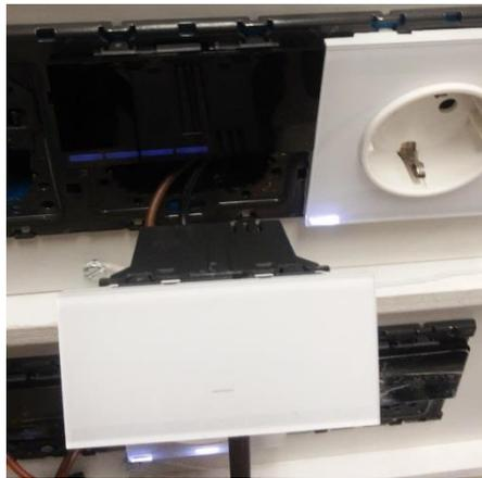
*Ilustración 5: Dimmer AUREA actual extraído de la caja empotrada en la que se puede observar la tecla conectada al back con su conexión a la red eléctrica y a la carga a regular*
