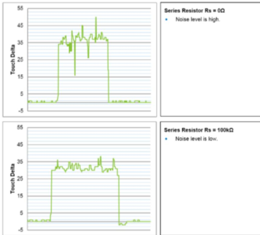
Ilustración 39: Capturas del ruido cuando se produce variación de la señal con touch sin resistencia en serie (Superior) y con una de 100kΩ (Inferior) [6]
