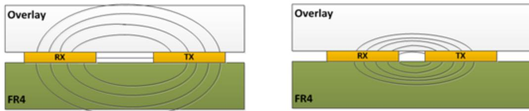
Ilustración 58: Representación de las líneas del campo eléctrico entre dos electrodos RX y TX [3]
