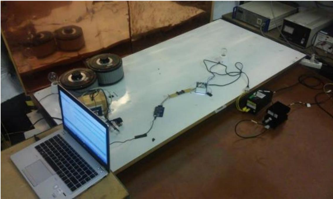
*Ilustración 25: Set-up del ensayo de Inmunidad Conducida y de la monitorización de la tecla versión self*
