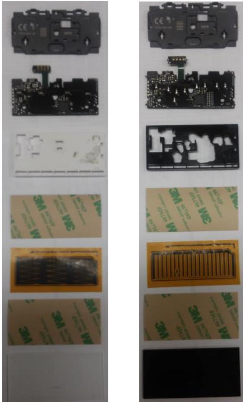
Ilustración 21.b: Despiece de la tecla dimmer AUREA versión Self (Izq.) y Mutual (Der.) en disposición de ensamblado. En orden ascendente: Acabado PMMA, Adhesivo 3M, lámina poliamida con el slider correspondiente, adhesivo 3M, esqueleto plástico, PCA y tapa de plástico anterior.
