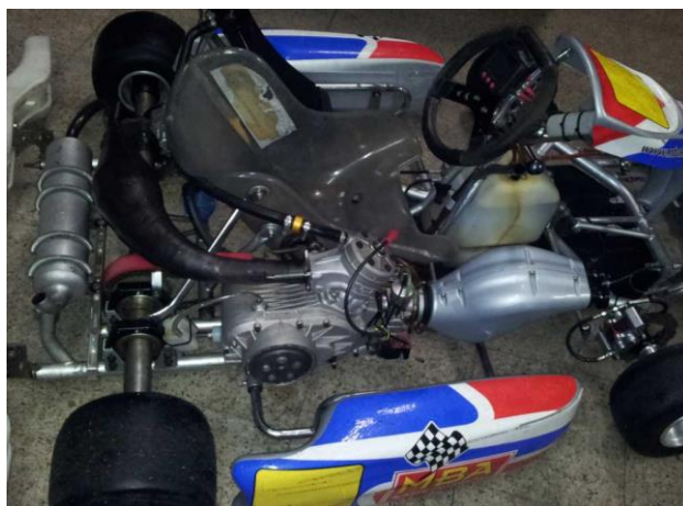
Figura 4: Configuración típica de un kart 125 cc.
