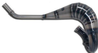
Figura 55: Ejemplo de fabricación artesanal de un escape de un motor 2T
