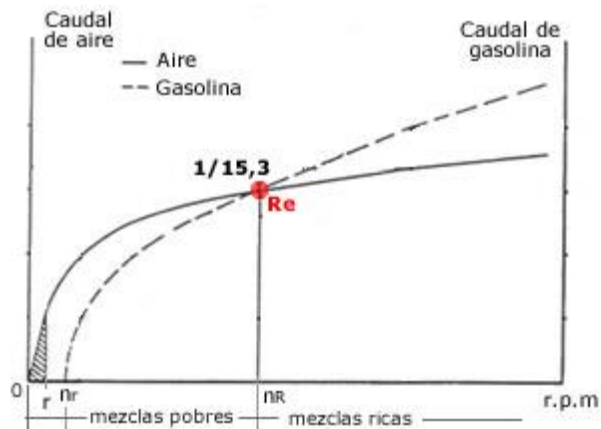
Figura 16: Curvas de dosificación de un carburador elemental
