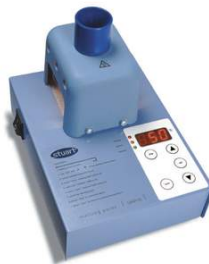
Figura 39. Aparell de mesura del punt de fusió
