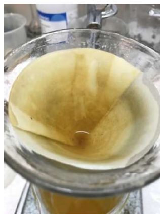
Figura 51. Sòlid de grànuls fins dipositat en el filtre
