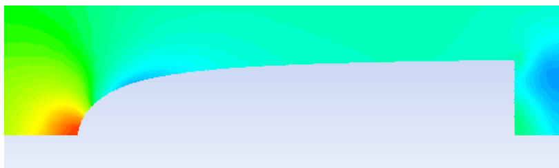
Figura 5.5 Perfil de velocidades de la parte superior del cuerpo semiinfinito de Rankine
