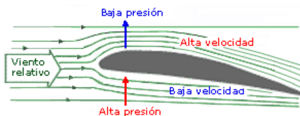
Figura 3.4 Presión y velocidad en el ala de un avión [4]
