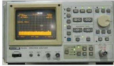
**Figura 5.2.** Analizador de espectros *Advantest* modelo *R4131D*.
