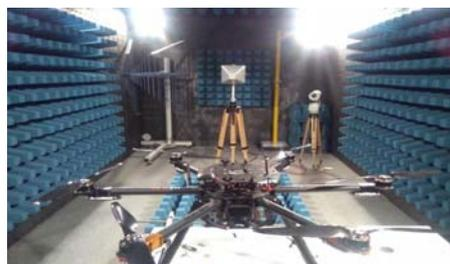
**Fig. 5.12.** Dron 3 colocado en la cámara con la antena más directiva y que emite a frecuencias más elevadas colocada para empezar la prueba.
