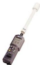
**Fig. 5.1.** Sonda de campos electromagnéticos.
