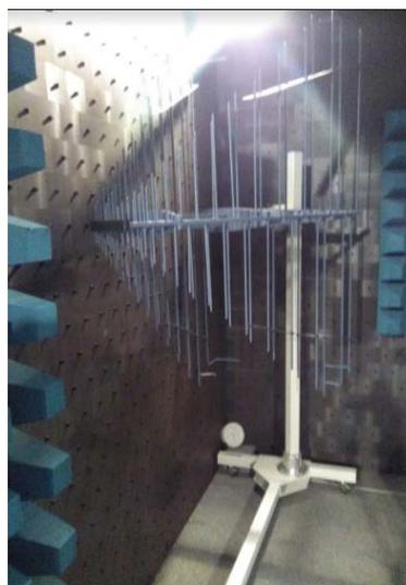
**Fig. 5.10.** Antena 2 de la cámara anecoica.
