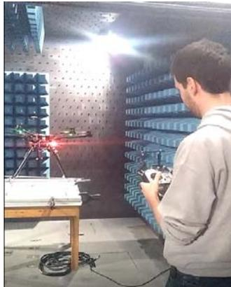
**Figura 5.13.** Dron 2 en vuelo en la cámara anecoica.
