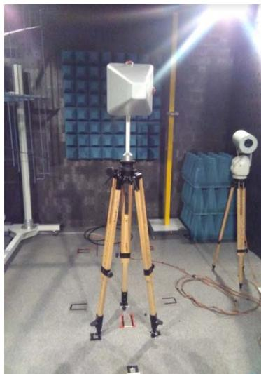
**Fig. 5.9.** Antena 1 de la cámara anecoica.
