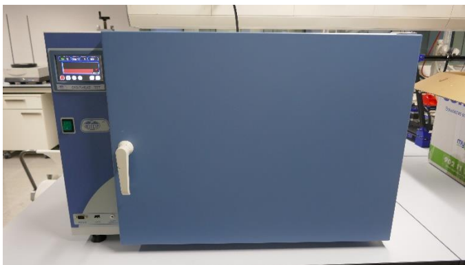
Figura 3.24. Forn model "P SELECTA Digitheat TFT" que treballa a 90°C.
