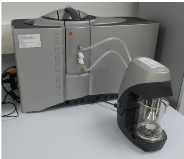
Figura 3.5. Visió general del Mastersizer.
