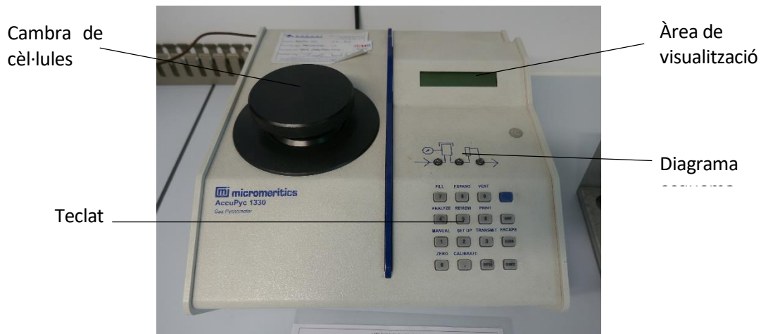
Figura 3.6. Picnòmetre d'Heli (Accupyc 1330) Micromeritics.
