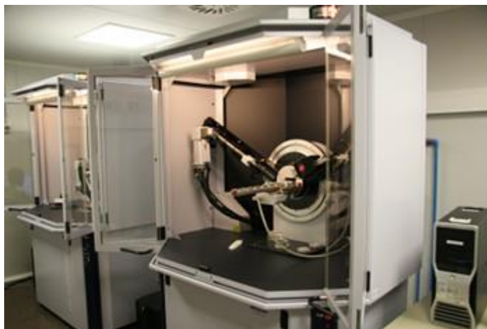
Figura 3.29. Equipament per a la difracció de raigs X, Bruker D8 Advance. [40]
