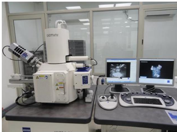
Figura 3.1. Imatge del microscopi FESEM [26].
