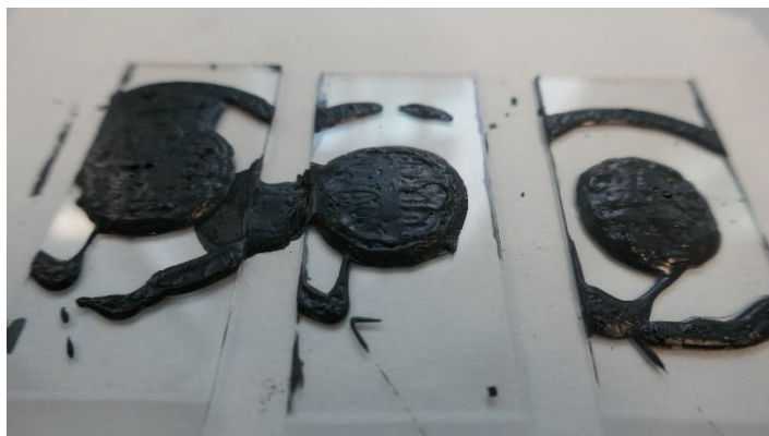
Figura 4.10. Mostres que no han mantingut la consistència un cop han estat impreses.
