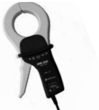
Figura 10.14. Analitzador elèctric AR6 + accessoris. a) Analitzador de xarxes, b) Pinça amperimètrica rígida CPR-500, c) Pinça amperimètrica flexible C-flex, d) Muntatge de les pinces C-Flex.
