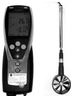
Figura 10.12. Multímetre + sonda de velocitat tipus molinet.
