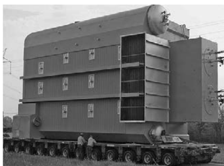
Figura 7.6. Caldera aquotubular de vapor sobreescalfat.
