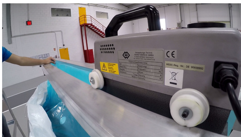
Figura 7.9. Soldadora sobre estructura de apoyo.
