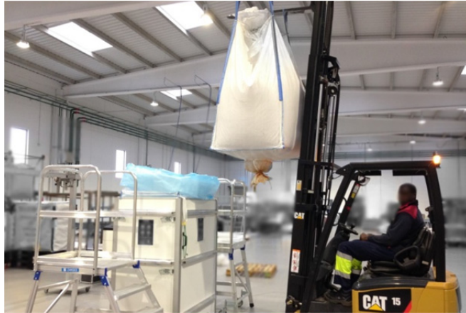
Figura 7.6. Llenado de envase ProX en molde desde contenedor flexible normal.
