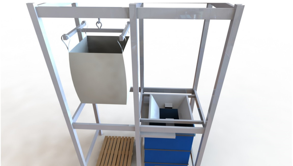
Figura 7.13. Elevación del contenedor flexible con el producto de origen.
