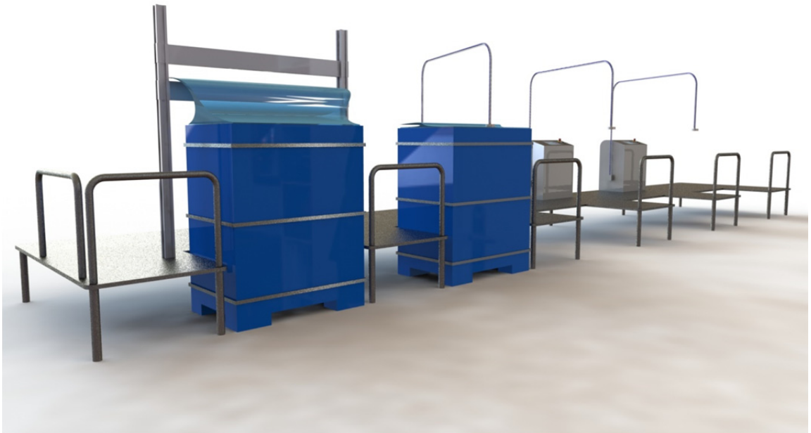
Figura 7.19. Línea de 4 módulos de operaciones de vacío e inyección de gas.
