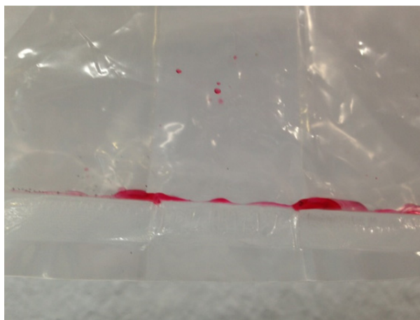
Figura 7.3. Comprobación antifugas en línea de soldadura.
