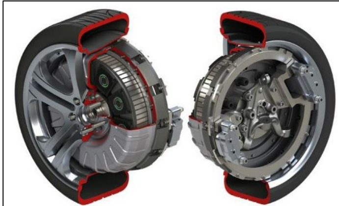
Figura 3.6. Ejemplo de “in-wheel” motor de Protean’s electric (Hybrid Cars, 2012)
