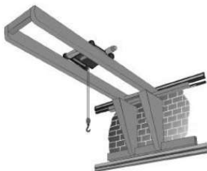
Figura 19: Puente grúa ménsula
