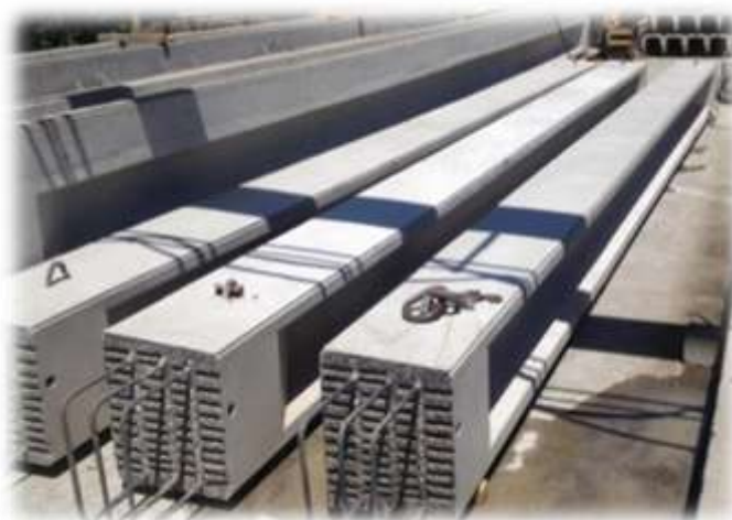
Figura 10: Vigas pretensadas - Fuente: Tensocret.cl
