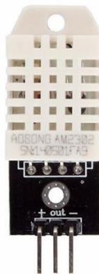
Imagen 29. Sensor de temperatura y humedad DHT22
