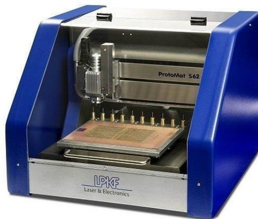
Imagen 71. Máquina de fabricación de PCBs. LPKF.
