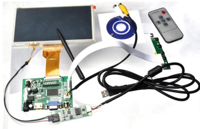
*Imagen 27. Componentes que conforman la pantalla táctil AT070TN90*
