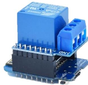
Imagen 15. Conexión D1 mini pro y Relé “Shield”
