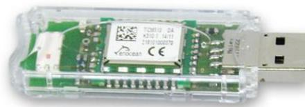
Imagen 21. Módulo receptor USB300
