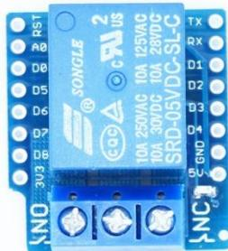
Imagen 14. Relé electromecánico “Shield”
