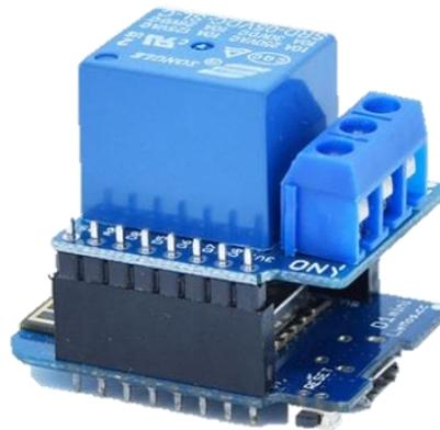
*Imagen 53. Conexión D1 mini pro y Relé electromecánico "Shield" (sin fuente de alimentación)*
