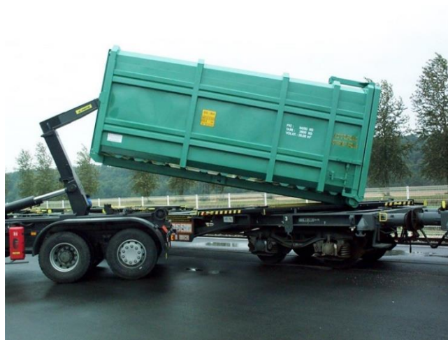
Figura 5-6. Camió equipat amb braç hidràulic durant el procés de càrrega/descàrrega d'un contenidor de 20 peus en un vagó Multi-berces
