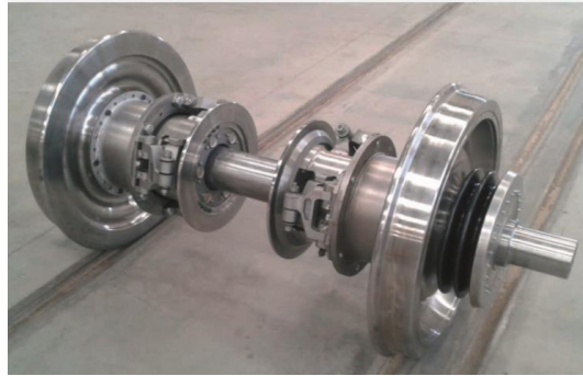
Figura 12-7. Eix d'ample variable OGI per a vagons de mercaderies en fase d'homologació
