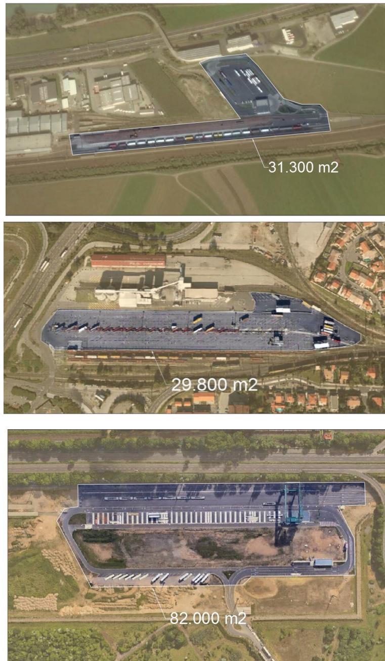
Figura 6-3. Àrea de les terminals d'autopista ferroviària a Wörgl (Àustria), El Voló (França) i Colònia (Alemanya) de dalt a baix
