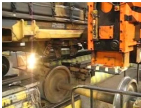
Figura 12-4. Moment en el que un eix d'un vagó és substituït en els instal·lacions de Transfesa a Hendaia
