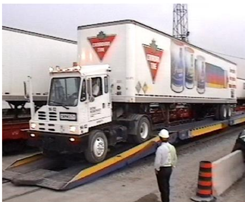
Figura 5-5. Càrrega d'un semiremolc en un tren Iron Highway als Estats Units (dreta) i representació gràfica resumida de tots els components d'aquest sistema (esquerra).
