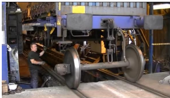
Figura 12-3. Imatge que capta el canvi d'eixos a les instal·lacions de Transfesa a Cervera de la Marenda, en aquest cas els eixos entren fins a situar-se sota el vagó en la mateixa direcció longitudinal al tren
