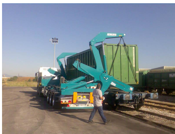
Figura 5-7. Camió tràiler equipat amb un carregador lateral de contenidors de fins a 40 peus efectuant una transferència a un vagó portacontenidors en una terminal ferroviària.
