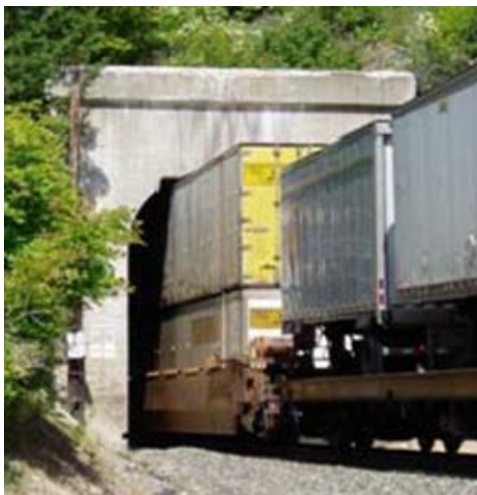
Figura 12-8. Tren compostat per vagon portacontenidors apil·lats a doble altura i autopista ferroviària als EUA
