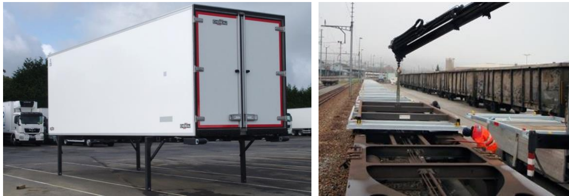
Figura 5-21. Vista d'un cos mòbil frigorífic estacionat (imatge de l'esquerra). Instal·lació d'un marc adaptador ContainMover a un vago convencional portacontenidors (imatge de la dreta).
