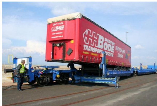
Figura 5-15. Vagó MegaSwing just en l'operació d'esser carregat/descarregat. Observi's el detall del braç estabilitzador.
