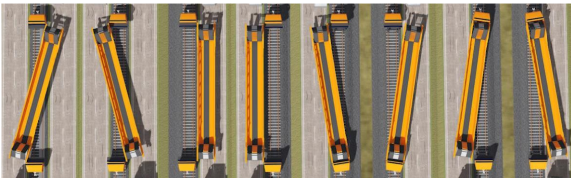
Figura 5-18. Vista en planta de les 8 possibles configuracions que pot adoptar el vagó Flexiwagon per tal de carregar o descarregar els conjunts sencers de semi-remolcs i unitats tractores.
