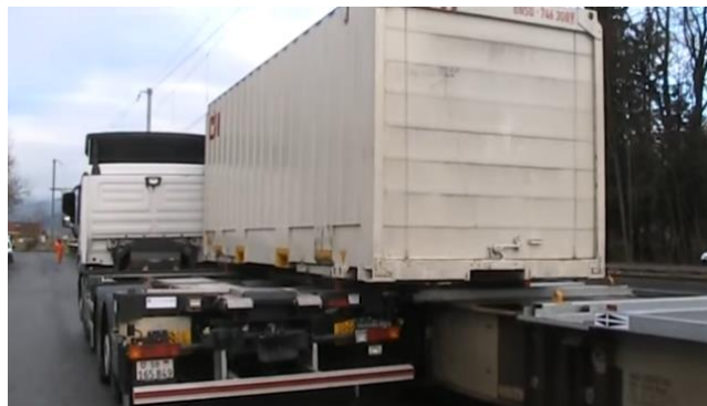
Figura 5-22. Camió i vago equipats amb els elements de la tecnologia ContainMover efectuant una transferència d'un cos mòbil horitzontalment.
