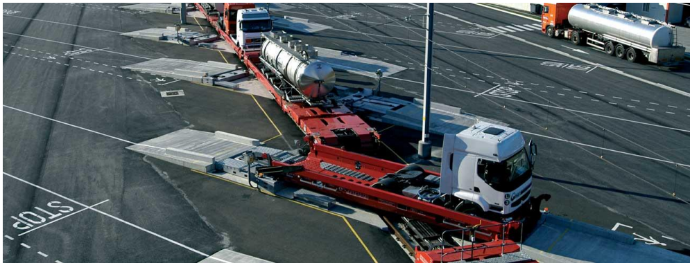
Figura 5-9. Primera generació de vagons Modalohr a la terminal d' El Voló (França).
