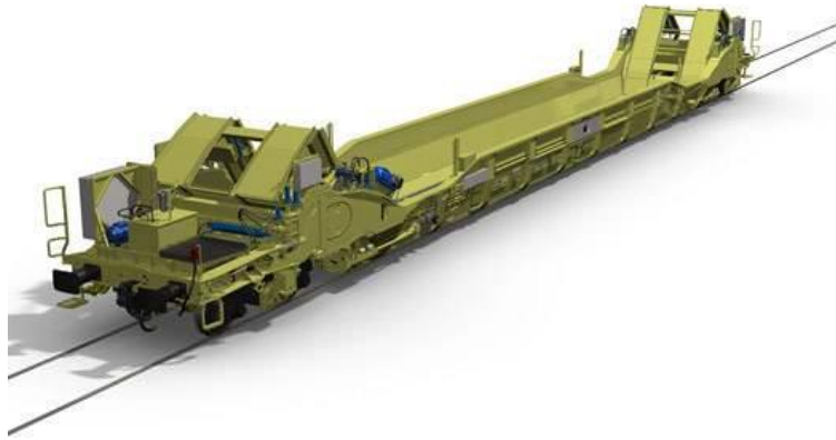
Figura 5-17. Recreació en tres dimensions d'un vagó Flexiwagon.
