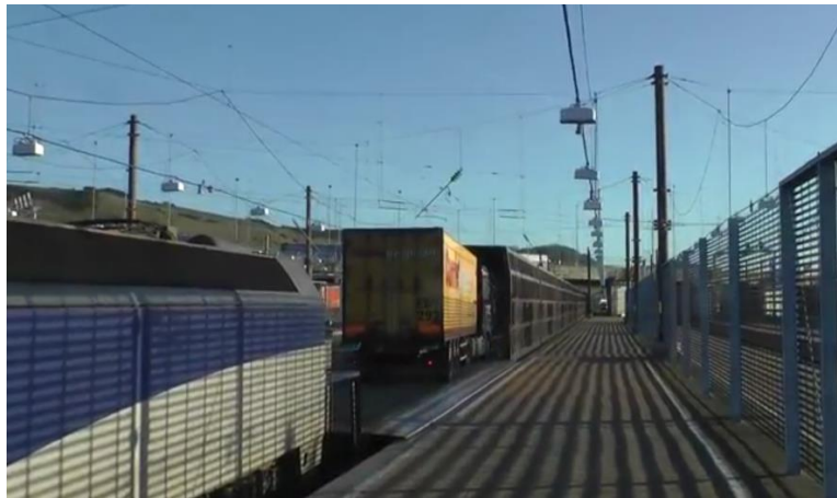
Figura 5-8. Llançadora de l'Eurotunnel per al transport de vehicles pesants en el moment en què un camió accedeix a la plataforma de càrrega
