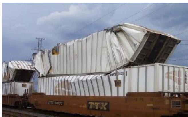
Figura 12-9. Tren que transportava contenidors apilats a doble altura i que fou redirigit per una altra línia de gàlib insuficient. Incident ocorregut l'any 2008 al túnel de Windsor-Detroit (EUA).
