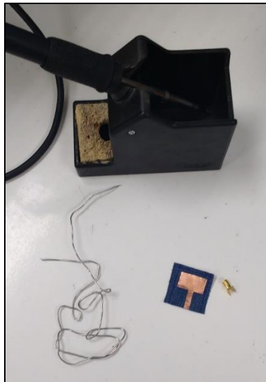
Figura 54: Soldador, estaño, antena y el puerto.
