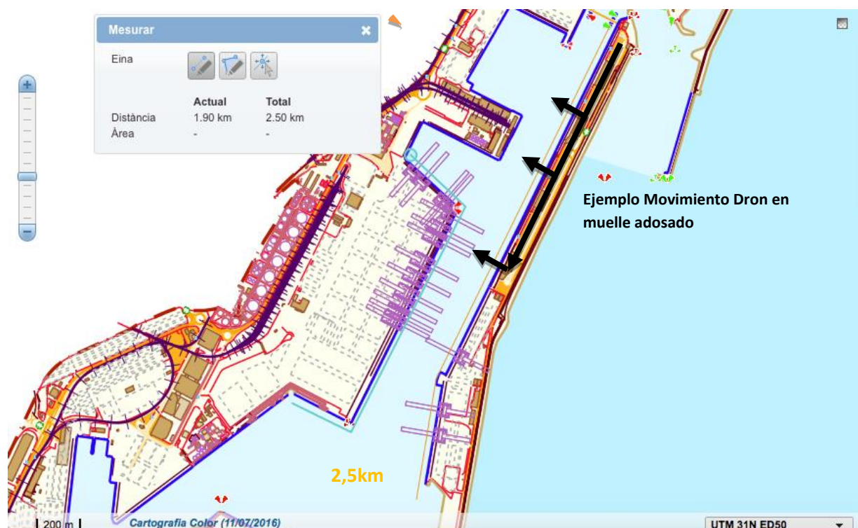
Ilustración 22. Línea de atraque y ejemplo de plan de vuelo del dron en muelle adosado del Port de Barcelona
