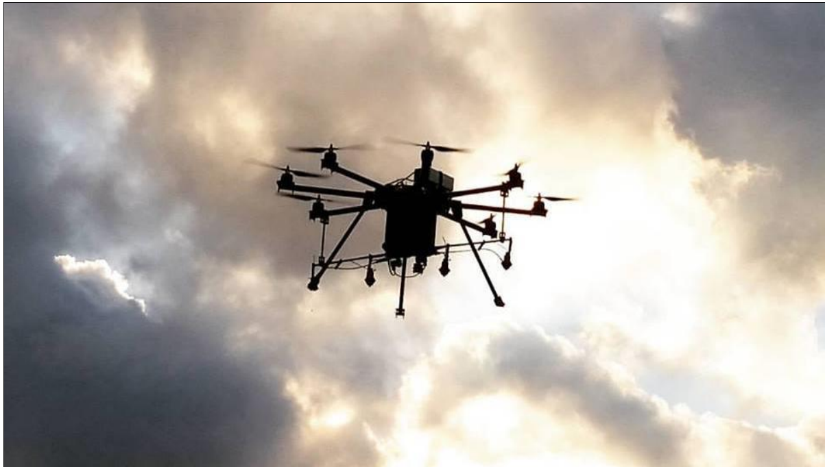
Ilustración 8. RPAS Multirrotor octocóptero fumigador volando (Merino, 2016)
