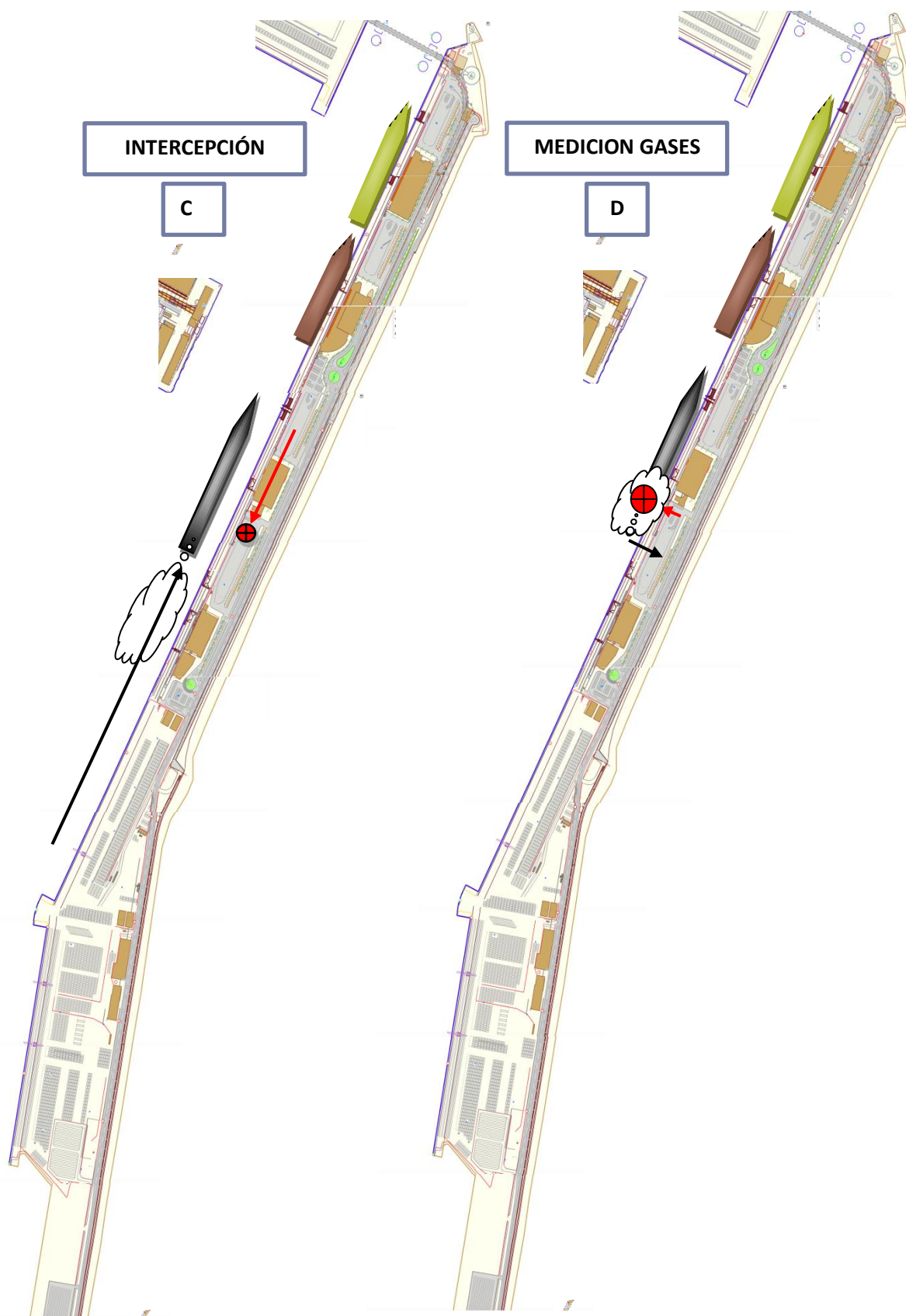
Ilustración 24. Esquema 2 del desplazamiento del dron a la llegada del buque a puerto para analizar los gases expulsados
