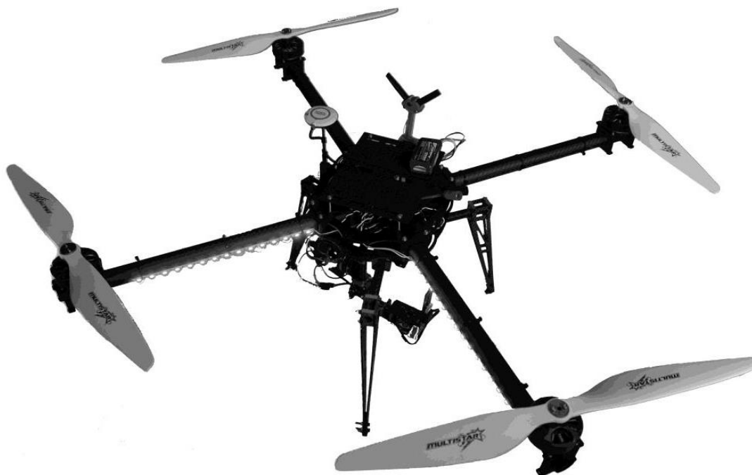
Ilustración 18. Sistema Dron RPAS con estabilizador de cámara (Merino, 2016)
