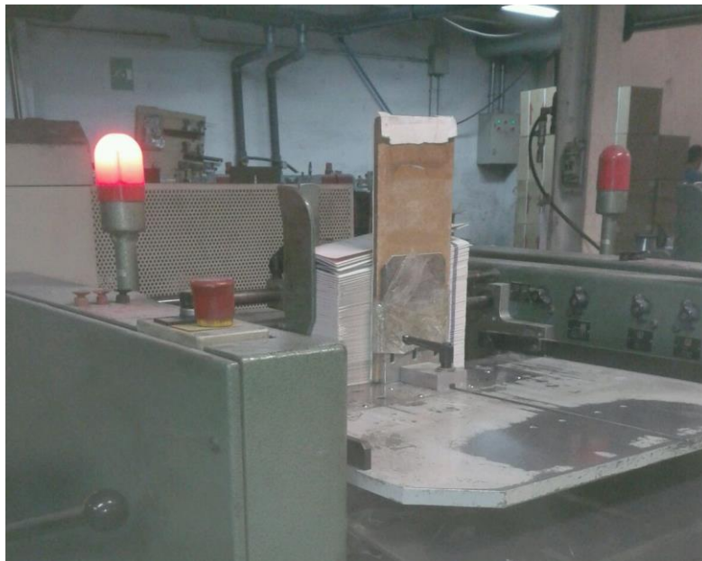
Figura 15. Aviso lámpara marcador por capot delantero abierto.
