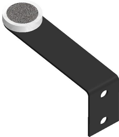
Figura 41a. Montaje de escuadra y receptor.
