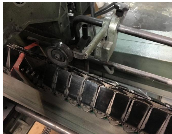
Figura 21b. Posición adquirida por la guía cuando no hay encallada.
