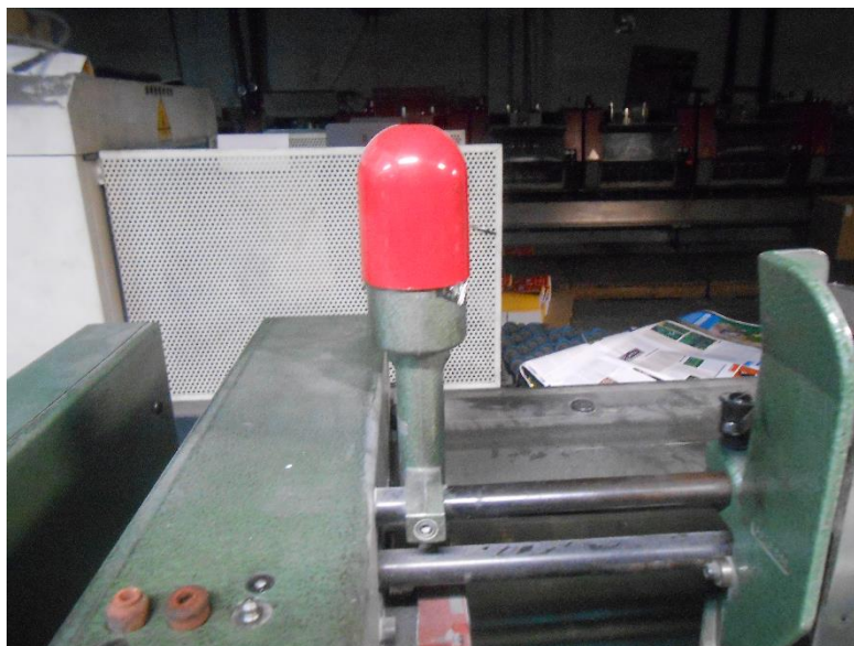
Figura 8. Vista en detalle de lámpara de aviso del marcador
