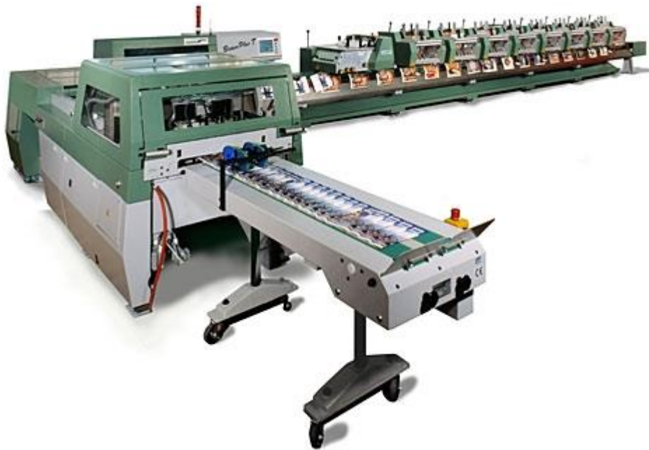
Figura 1. Máquina Müller Martini Grapadora Alzadora Industrial con salida en cinta.
