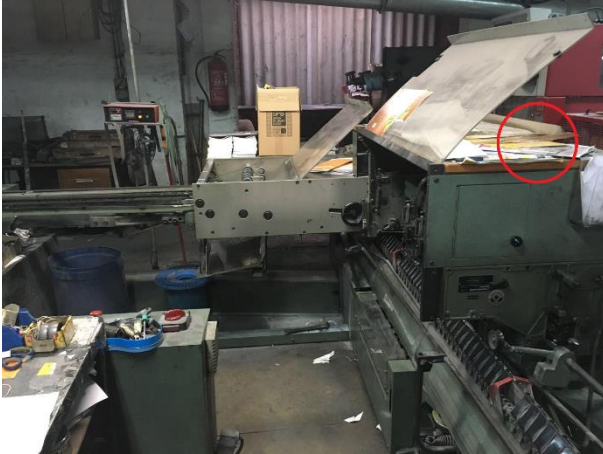
Figura 47a. Lugar de instalación de la columna de señalización.
