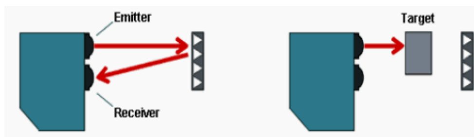
Figura 12. Sistema de detección por reflexión sobre catadióptrico.
