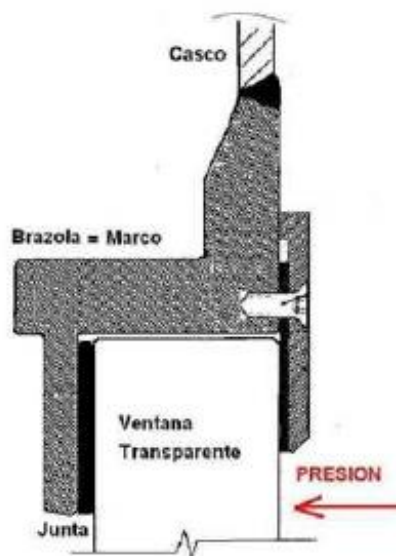
Figura 28 Esquema de l'encaix entre metacrilat i marc
