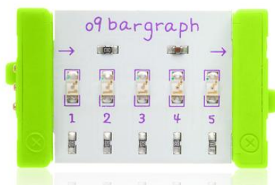
Figura 17. Mòdul LittleBits que s'il·lumina quan el mòdul anterior detecta so.
