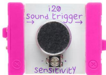
Figura 16. Mòdul LittleBits que detecta uns certs nivells de sorolls.
